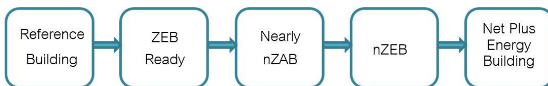
ภาพที่ 3 แนวคิดการพัฒนาอาคารผลัดพัสด้านพลังงานเป็นบวก (กมล, 2561)
