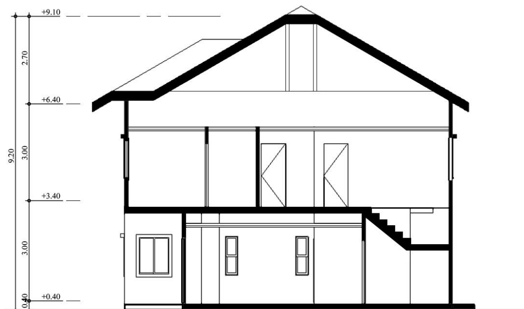
ภาพที่ 28 รูปตัดตามยาว บ้านเสนา Oxy Smart
