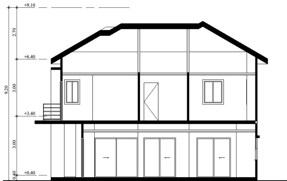
ภาพที่ 27 รูปตัดตามขวาง บ้านเสนา Oxy Smart
