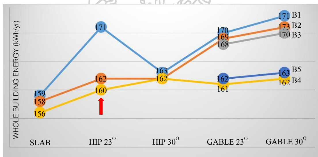
ภาพที่ 43 การเปรียบเทียบอิทธิพลของสัดส่วนอาคาร ทิศทางการวาง และรูปทรงหลังคาที่มีต่อค่าพลังงานรวม
