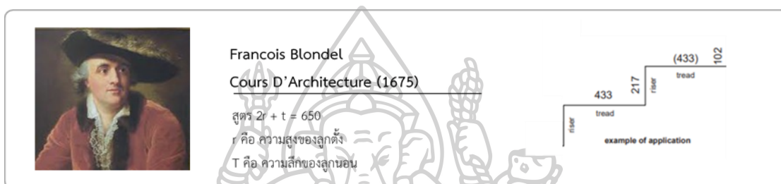
ภาพที่ 5 แสดงระยะลูกตั้งลูกนอนตามตำรา Cours D'Architecture, Francois Blondel ที่มา: (Koolhaas et al., 2014)
