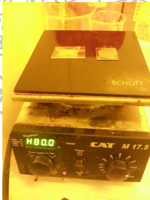
ภาพที่ 5 การอบอิเล็กทรอนิกส์ที่อุณหภูมิ 80°C
