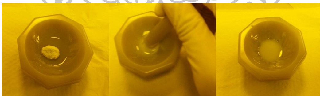
ภาพที่ 3 การผสมตัวเชื่อมประสานกับอนุภาคนาโนซิงก์ออกไซด์ภายในโถรงบดสาร เพื่อเตรียมสารละลายผสม
