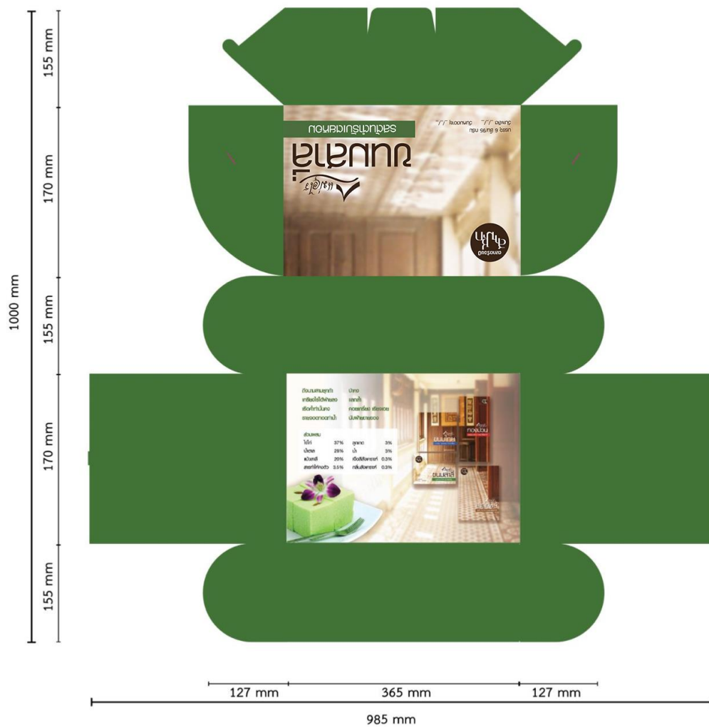
ภาพที่ 3 ภาพเขียนแบบบอขนาด แบบ B1 “บันทึกความทรงจำ” ขนมสาลี ที่มา : ออกแบบโดย ศศิณัฐ์ กิจสุภาไพศาล
