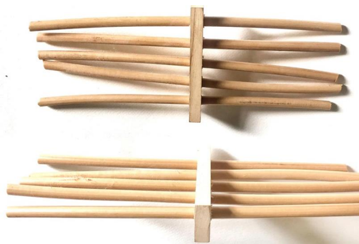
ภาพที่ 110 การยึดเส้นหวาย 5 เส้น ระบายแบนนอนจากการเจาะรูไม้ ที่มาจาก : ผู้วิจัย
