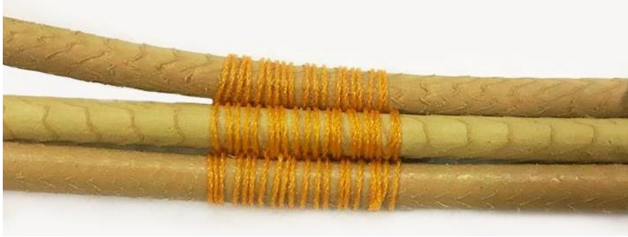
ภาพที่ 116 การยัดเส้นหวายด้วยการถักเงื่อนหัวแมลงวันแบบถักจากไนลอนและยัดติดกันด้วยเงื่อน หางปลาช่อน
