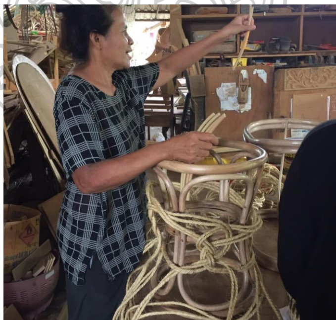
ภาพที่ 150 ครอบเชือกมะนิลาที่โครงเก้าอี้ (รูปแบบ A) ที่มาจาก : ผู้วิจัย
