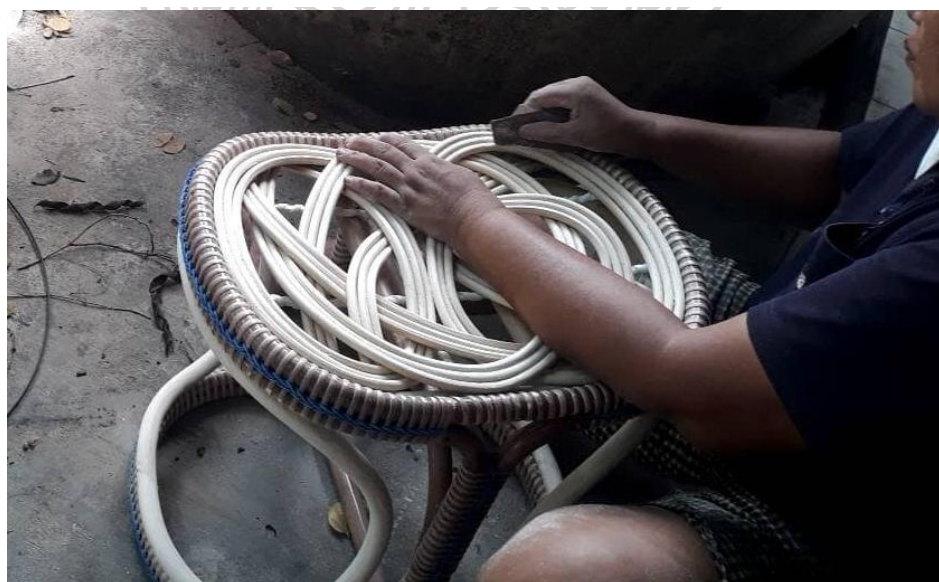
ภาพที่ 152 บริเวณที่นั่งที่สานด้วยหวายแท้และเก็บรายละเอียด (รูปแบบ B)
