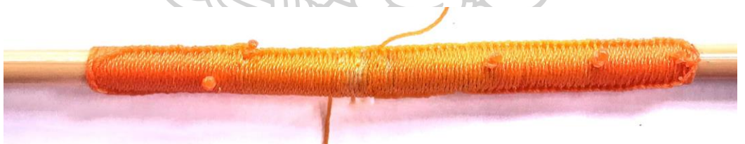
ภาพที่ 105 การทำข้อต่อโดยใช้เชือกไนลอนในการถักสายสัญญาณแบบถัก
