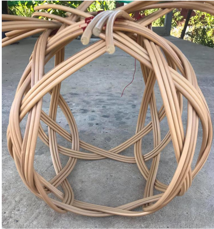
ภาพที่ 93 การสานรังงอบ 4 ขา จากหวายเทียม ขนาด 45x45 cm. ที่มาจาก : ผู้วิจัย
