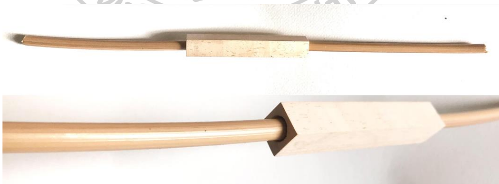
ภาพที่ 102 การทำข้อต่อแบบเจาะไม้ทะลุ สอดหวายเทียม 1 เส้น
