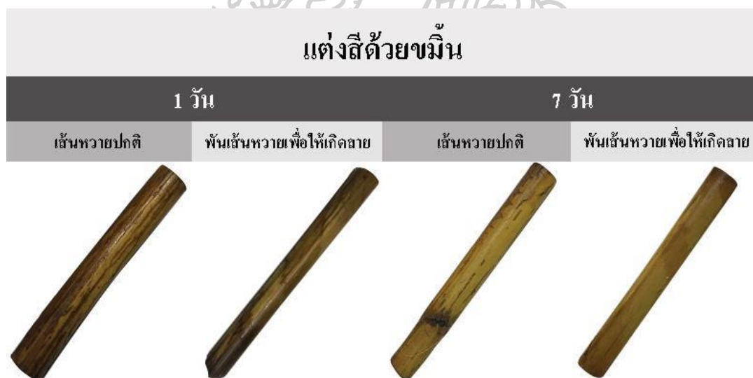
ภาพที่ 58 การย้อมสีเส้นหวายด้วยสีธรรมชาติ (ขมิ้น) ที่มาจาก : ผู้วิจัย
