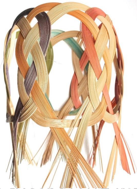
ภาพที่ 91 การสานรังอบ 6 ขา จากเส้นตอกที่ผ่านการย้อมสีเคมีด้านเดียวสานสลับกัน ที่มาจาก : ผู้วิจัย
