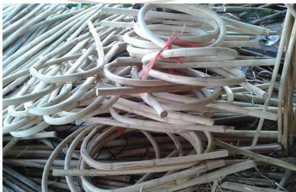
ภาพที่ 52 หวายที่ผ่านการอบและตัด
