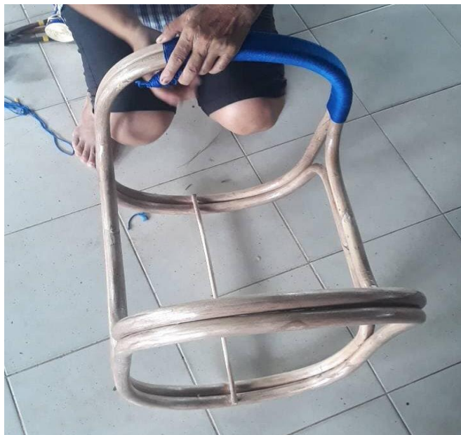
ภาพที่ 149 ถักเงื่อนหางปลาซ้อน (รูปแบบ B) ที่มาจาก : ผู้วิจัย
