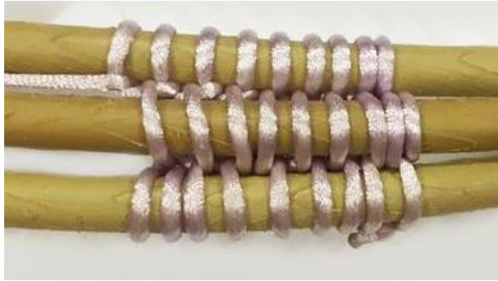
ภาพที่ 119 การยึดเส้นหวายด้วยการถักเงื่อนหัวแมลงวันจากเส้นไหมญี่ปุ่น ที่มาจาก : ผู้วิจัย
