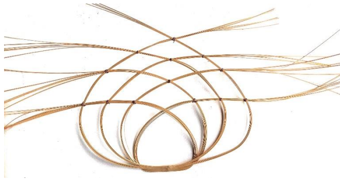
ภาพที่ 72 การขึ้นรูปเส้นตอก 1 เส้นโดยการถักยึดไว้ด้วยลวด ที่มาจาก : ผู้วิจัย
