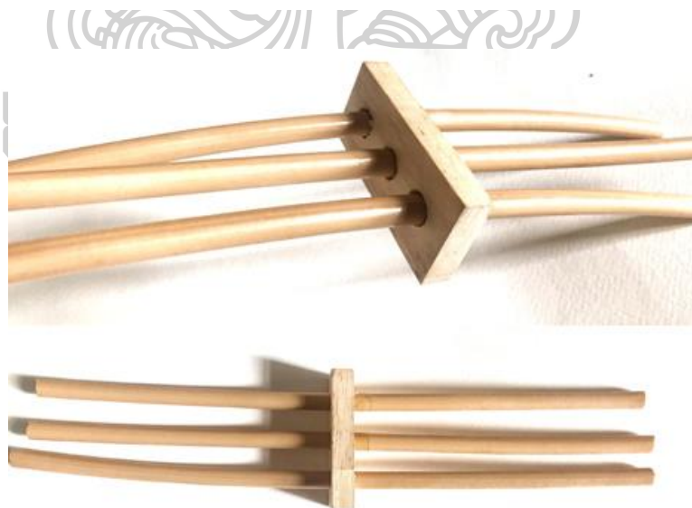
ภาพที่ 109 การยึดเส้นหวาย 3 เส้น ระนาบแนวนอนจากการเจาะรูไม้ ที่มาจาก : ผู้วิจัย
