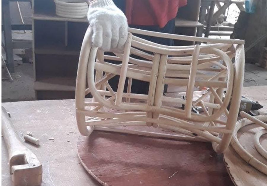
ภาพที่ 145 ตัดหวายตามแบบที่ต้องการและตียึดด้วยไม้ (รูปแบบ A) ที่มาจาก : ผู้วิจัย
