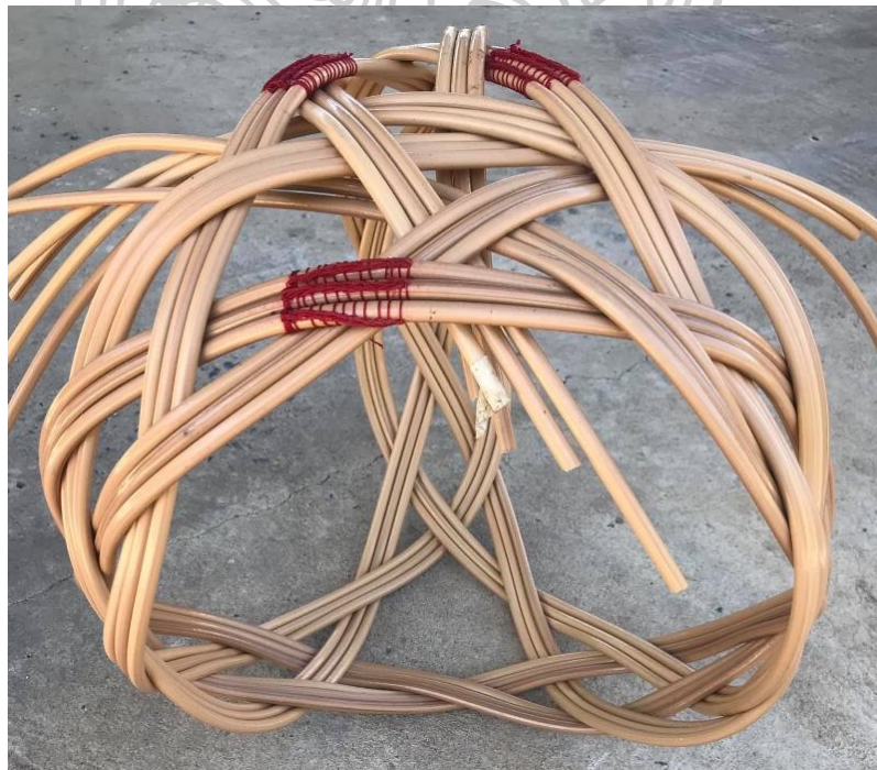
ภาพที่ 94 การสานรังงอบ 3 ขา จากหวายเทียม ขนาด 45x45 cm. ที่มาจาก : ผู้วิจัย
