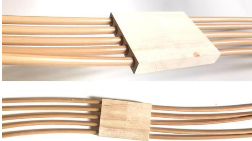
ภาพที่ 103 การทำข้อต่อแบบเจาะไม้ทะลุ สอดหวายเทียม 5 เส้น
