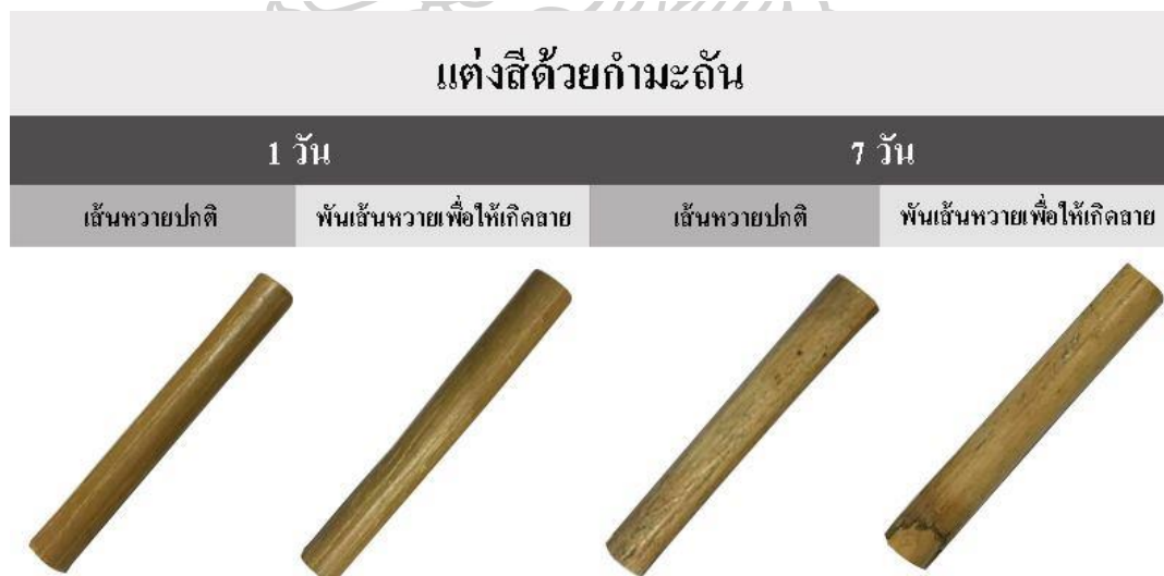
ภาพที่ 68 การย้อมสีเส้นหวายด้วยสีธรรมชาติ (กำมะถัน) ที่มาจาก : ผู้วิจัย
