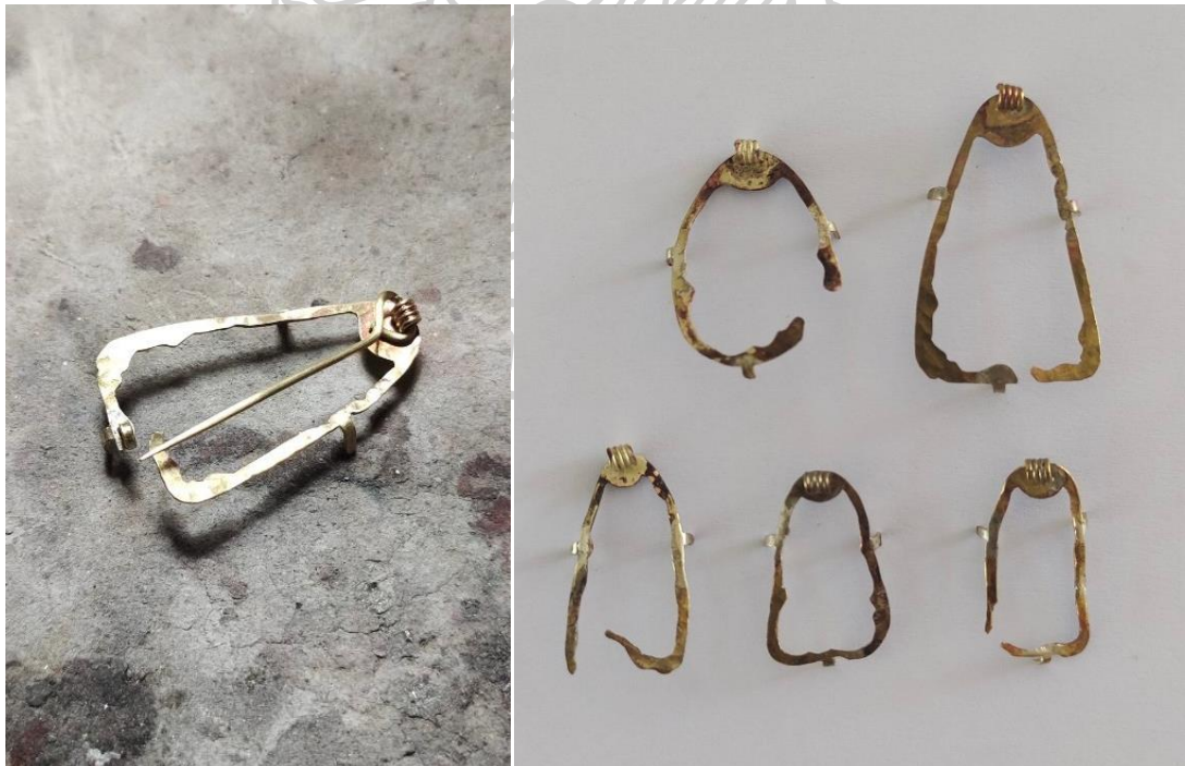
ภาพที่ 86 การเชื่อมลวดเพื่อล๊อคชิ้นงาน และเชื่อมส่วนประกอบของเข็มกลัด
