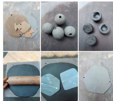
รูปภาพแสดงวิธีการกระบวนการผลิต ขั้นตอนที่ 1 : เตรียมดิน นวดดิน และปั้นดินตามรูปทรงที่ต้องการแบบ
