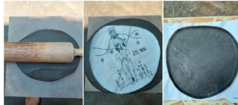
รูปภาพแสดงวิธีการกระบวนการผลิต ขั้นตอนที่ 1 : เตรียมดิน นวดดิน และปั้นดินตามรูปทรงที่ต้องการแบบ
