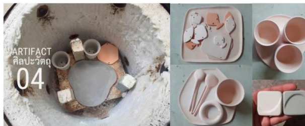
รูปภาพแสดงวิธีการกระบวนการผลิต ขั้นตอนที่ 2 : การเผาดิน แยกที่อุณหภูมิ 800c
