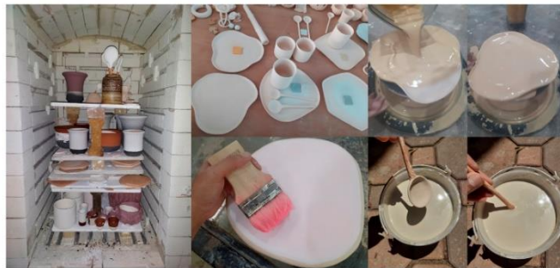
รูปภาพแสดงวิธีการกระบวนการผลิต ขั้นตอนที่ 3 : การเผาเคลือบที่ 1200c
