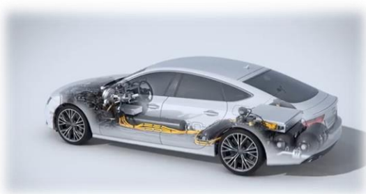
ภาพที่ 9 ต้นแบบรถยนต์ที่ขับเคลื่อนด้วยพลังงานจากเซลล์เชื้อเพลิง
