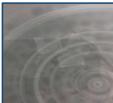
ภาพที่ 22 ตัวอย่างทดลองแช่อยู่ในถังน้ำ ที่ระดับความลึก 40 เซนติเมตร
