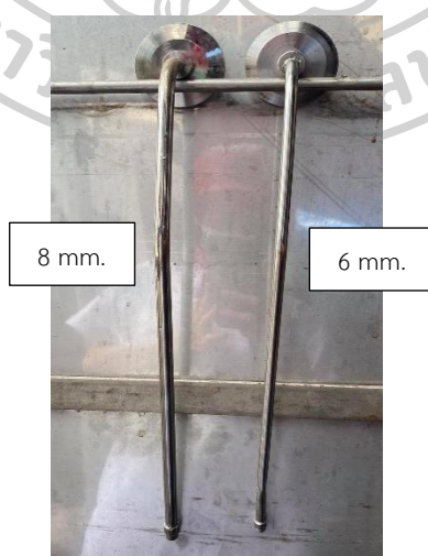
รูปภาพที่ 41 ขนาดท่อจ่ายสินค้านี้มี 2 ขนาด ได้แก่ ขนาดเส้นผ่านศูนย์กลาง 6mm. และ 8 mm.
