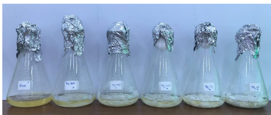
รูปที่ 3.3 แสดงการใส่ฟิล์มลงในอาหารเหลว (NB)
