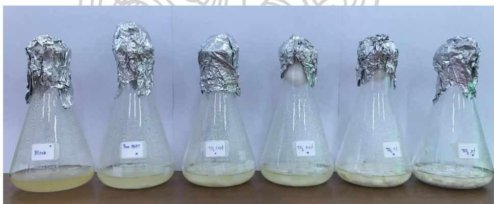
รูปที่ 3.4 แสดงการใส่ฟิล์มและเชื้อลงในอาหารเหลว (NB) และผ่านการบ่มแล้วเป็นเวลา 24 ชั่วโมง
