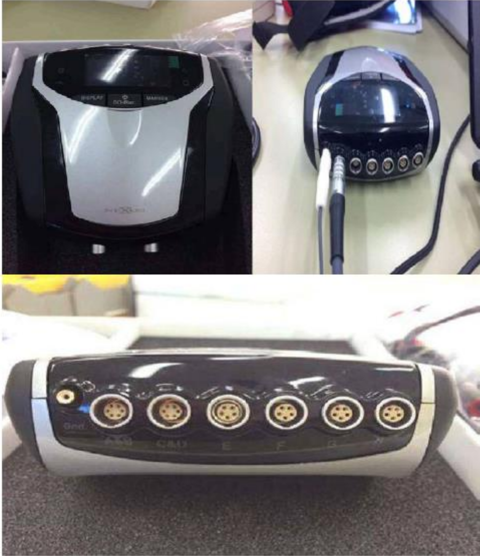
ภาพที่ 35 ลักษณะของเครื่องและจุดที่เชื่อมสาย EXG และสาย Ground
