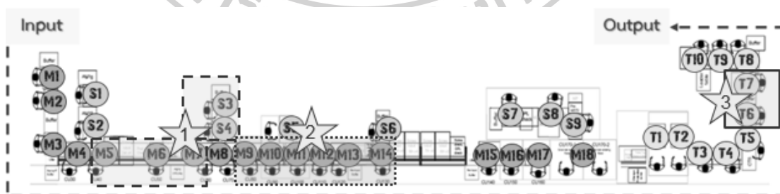
ภาพที่ 19 แผนผังสายการผลิตกระบวนการประกอบชิ้นส่วน 3 กลุ่มที่สนใจศึกษา
