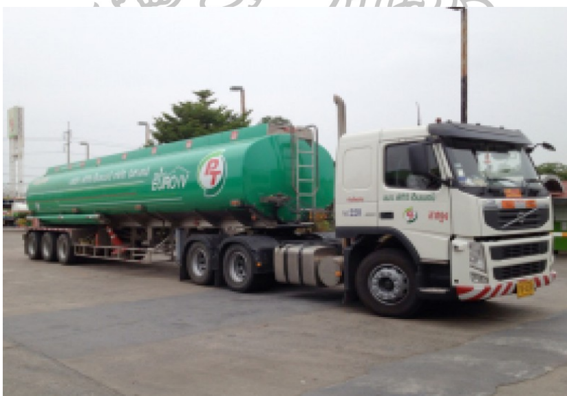
ภาพที่ 10 รถบรรทุกน้ำมันขนาด 54,000 ลิตร แบบ 8 ช่อง ที่มา: รถบรรทุกน้ำมัน, เข้าถึงเมื่อ 21 กุมภาพันธ์ 2559, เข้าถึงได้จาก http://www.7insure.com/webboard.html
