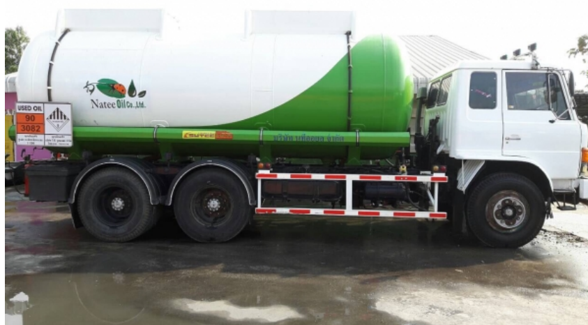
ภาพที่ 8 รถบรรทุกน้ำมันขนาด 16,000 ลิตร แบบแคปซูล ที่มา: รถบรรทุกน้ำมัน, เข้าถึงเมื่อ 21 กุมภาพันธ์ 2559, เข้าถึงได้จาก http://www.nanasupplier.com/ausubkanchang/p-137068
