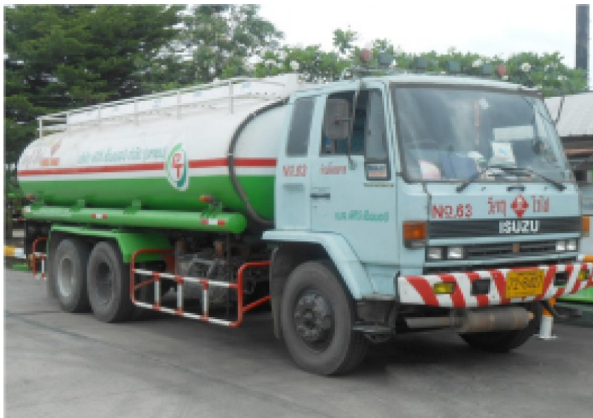
รูปภาพที่ 7 รถบรรทุกน้ำมันขนาด 16,000 ลิตร แบบ 5 ช่อง ที่มา: รถบรรทุกน้ำมัน, เข้าถึงเมื่อ 21 กุมภาพันธ์ 2559, เข้าถึงได้จาก http://www.b2bthai.com/Search/Product/Detail/163676.html
