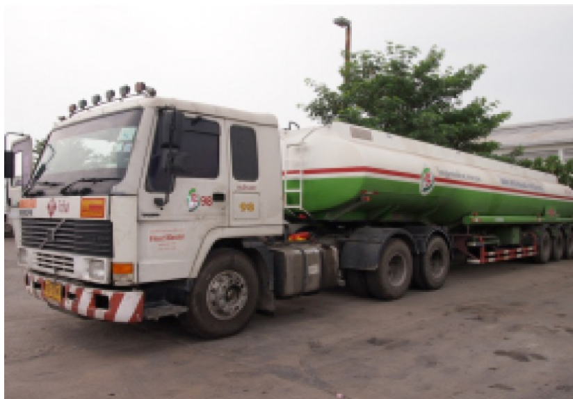
ภาพที่ 9 รถบรรทุกน้ำมันขนาด 50,000 ลิตร แบบ 8 ช่อง ที่มา: รถบรรทุกน้ำมัน, เข้าถึงเมื่อ 21 กุมภาพันธ์ 2559, เข้าถึงได้จาก http://nhltrailer.com/service2.php
