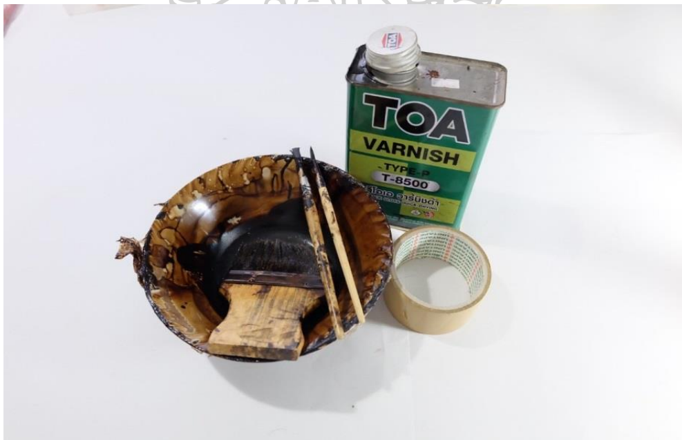
ภาพที่ 43 ภาพวัสดุอุปกรณ์ในการกั้น (ฉนวน) กั้นน้ำกรดกีดบนผิวหน้าแม่พิมพ์
