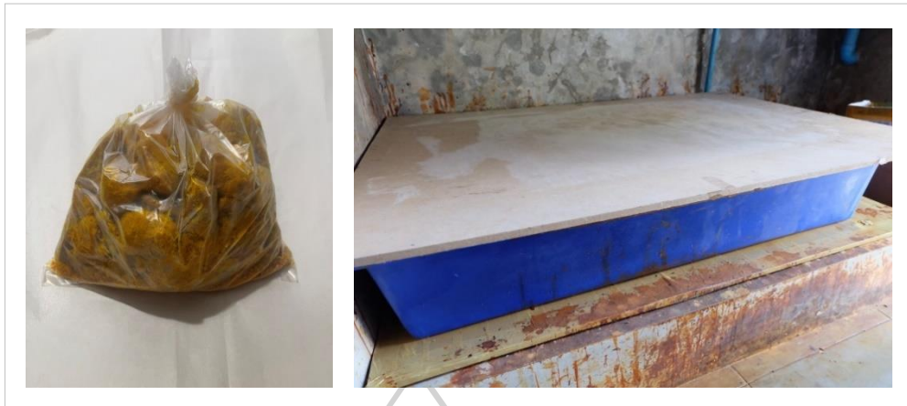
ภาพที่ 42 ภาพอุปกรณ์เคมีภัณฑ์ (กรด) และอ่างสำหรับ “(แช่)” กัดกรดแม่พิมพ์
