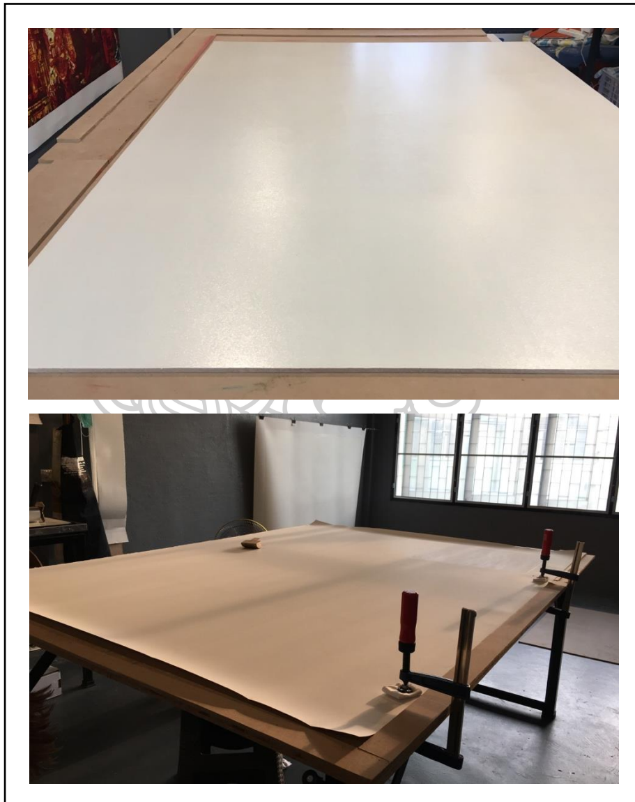
ภาพที่ 30 ภาพแสดงขั้นตอนการนำกระดาษและแม่พิมพ์มาวางเข้ามาร์คตัวแอล (L) และใช้เครื่องมือล็อก (C-Clamp) ยึดกระดาษไว้
