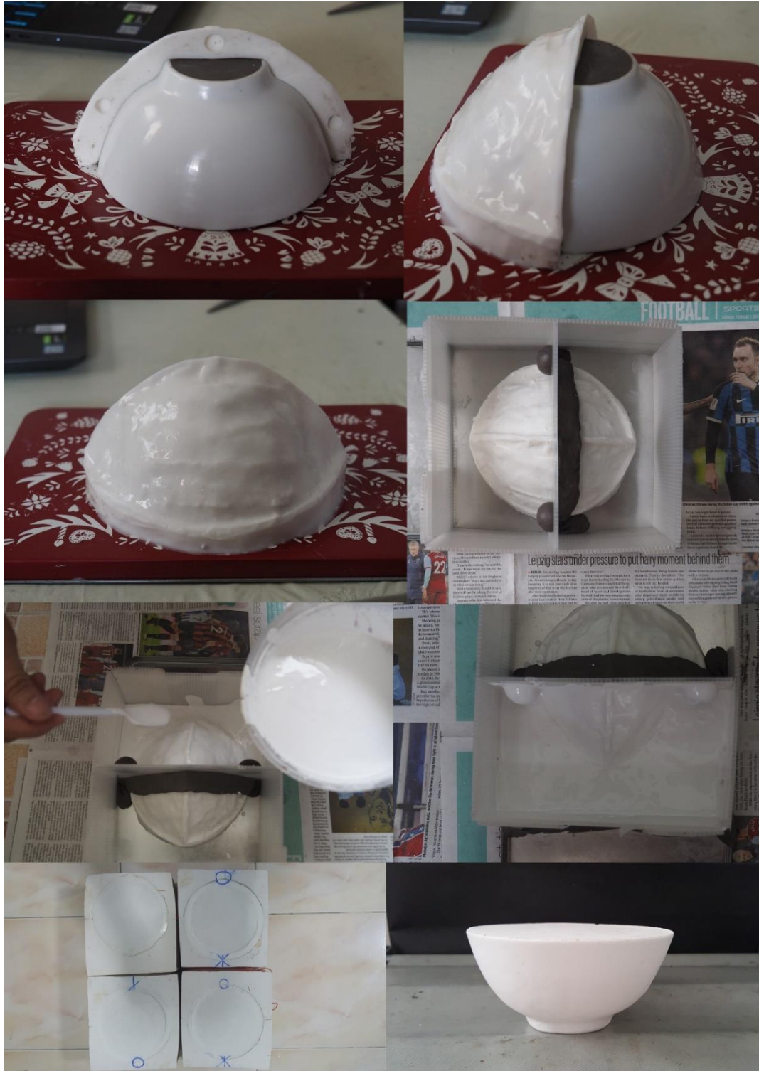
ภาพที่ 3. 41 ผลงาน จินนอกนา: พันระ กาลเวลาและความผูกพัน, ขั้นตอนทำพิมพ์หล่อด้วยปูนพลาสติก. ที่มา: (จूरिพร เพชรกิ่ง, 2564)
