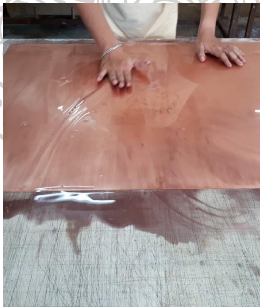
ภาพที่ 62 ภาพการขัดแผ่นแม่พิมพ์ (เพลททองแดง)
