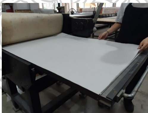
ภาพที่ 85 ขั้นตอนการวางกระดาษก่อนพิมพ์ 2
