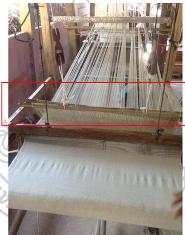
ภาพที่ 349 แสดงภาพตะกอโครงสร้าง บนที่ทอที่บ้านเพื่อสร้างผ้าสีพื้นของชาวไตลื้อ
