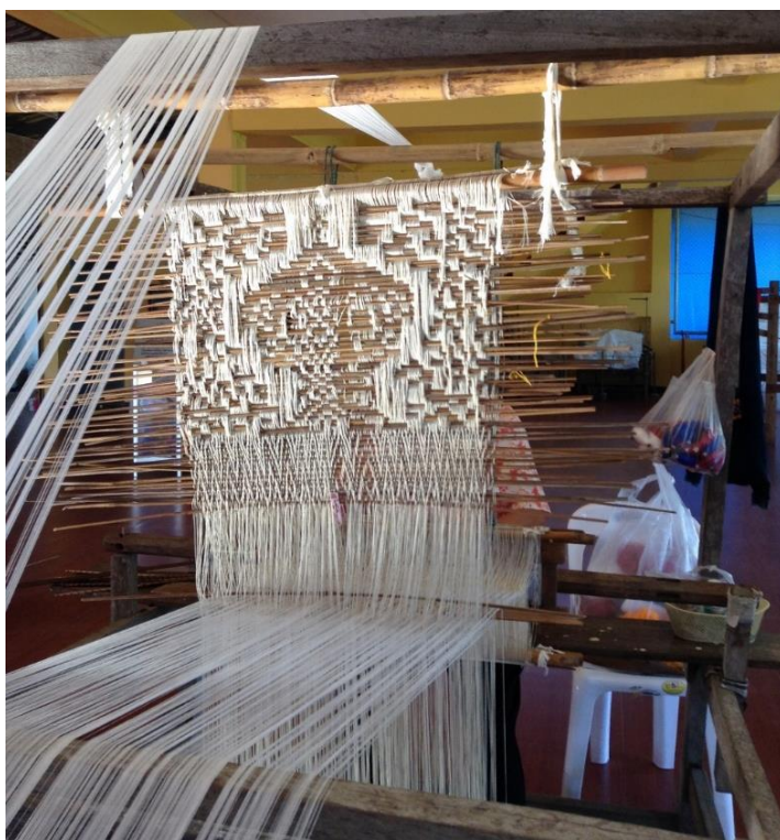
ภาพที่ 370 เขาโยงหรือการเพิ่มพื้นที่เส้นด้ายยืนทางแนวตั้ง อำเภอเชียงของ จังหวัดเชียงราย
