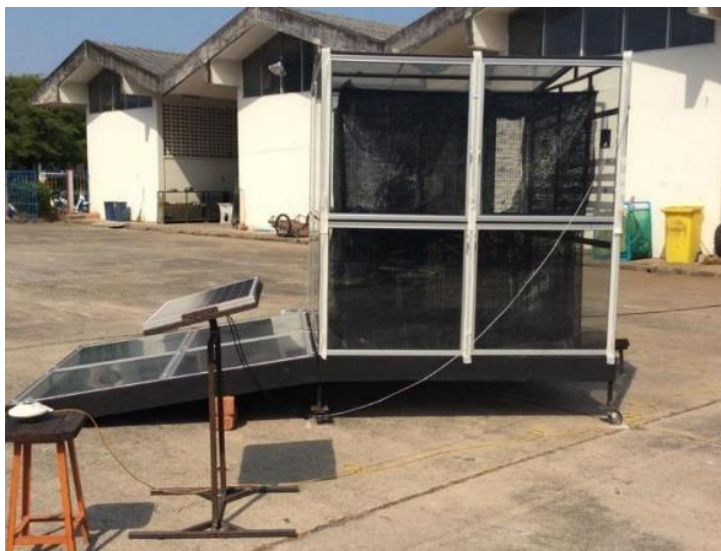
รูปที่ 25 เครื่องอบแห้งพลังงานแสงอาทิตย์แบบบังคับโดยมีการเสริมแผงรับรังสีอาทิตย์ ที่พัฒนาโดย วสันต์ จินธาดก และคณะ (2559)
