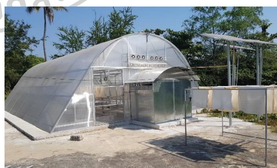
รูปที่ 61 การทดลองอบแห้งยางพาราแผ่นดิบ ด้วยเครื่องอบแห้งพลังงานแสงอาทิตย์แบบพาราโบลา โดมต้นแบบที่ มหาวิทยาลัยศิลปากร จังหวัดนครปฐม
