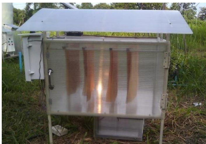
รูปที่ 28 เครื่องอบแห้งพลังงานแสงอาทิตย์ ที่มีการให้ความร้อนเสริมและระบบควบคุมอุณหภูมิ ที่พัฒนาโดย บุญยัง สิงห์เจริญ และคณะ (2559)
