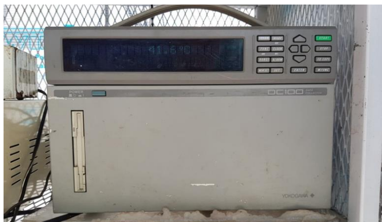
รูปที่ 51 เครื่องบันทึกข้อมูลแบบดิจิทัล (datalogger) ยี่ห้อ Yokogawa รุ่น DC100
