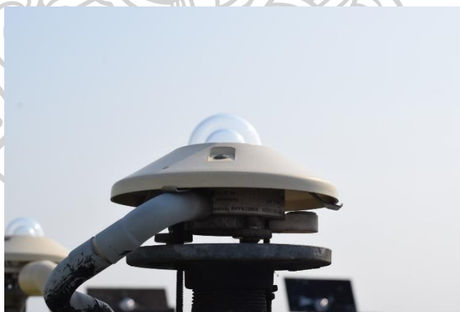
รูปที่ 46 เครื่องไพราโนมิเตอร์ Kipp and Zonen (model CMP11)
