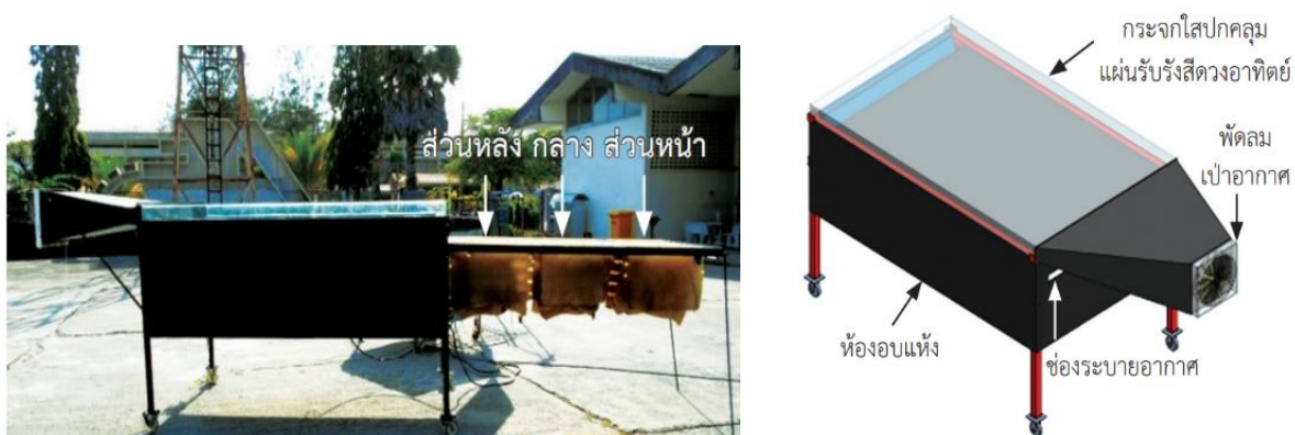
รูปที่ 26 เครื่องอบแห้งพลังงานแสงอาทิตย์แบบผนังด้านบนห้องอบแห้งเป็นแผ่นรับรังสีดวงอาทิตย์ (Jeentada et al., 2019)
