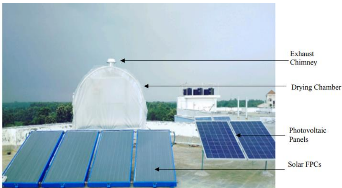
รูปที่ 27 เครื่องอบแห้งพลังงานแสงอาทิตย์แบบผสมที่ใช้แผ่นรับแสงอาทิตย์แบบแผ่นเรียบ สำหรับอบแห้งยางพาราแผ่นดิบ พัฒนาโดย Andharia et al. (2020)
