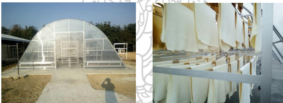
รูปที่ 66 การทดลองอบแห้งยางพาราแผ่นดิบที่ กลุ่มเกษตรกรชาวสวนยางพาราพงษ์ อำเภอสันติสุข จังหวัดน่าน
