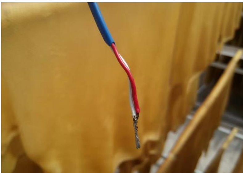
รูปที่ 47 เทอร์โมคัปเปิลชนิดเค (K-type thermocouple)
