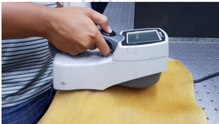
รูปที่ 59 การวัดสีแผ่นยางพารา
