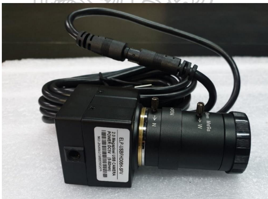
รูปที่ 47 กล้องถ่ายภาพสำหรับถ่ายภาพนิ่งจากภายในเครื่องอบแห้ง
