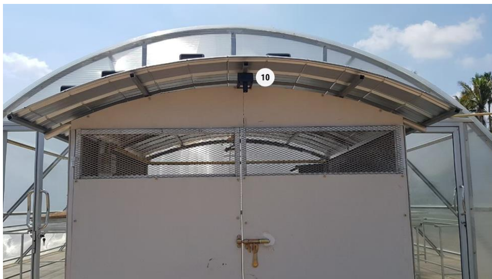
รูปที่ 42 การติดตั้งชุดเซนเซอร์วัดอุณหภูมิและความชื้นสัมพัทธ์ของอากาศแวดล้อม
