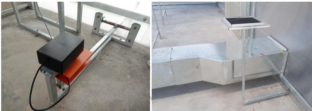
รูปที่ 46 การติดตั้งเครื่องชั่งน้ำหนักของตัวอย่างผลิตภัณฑ์
