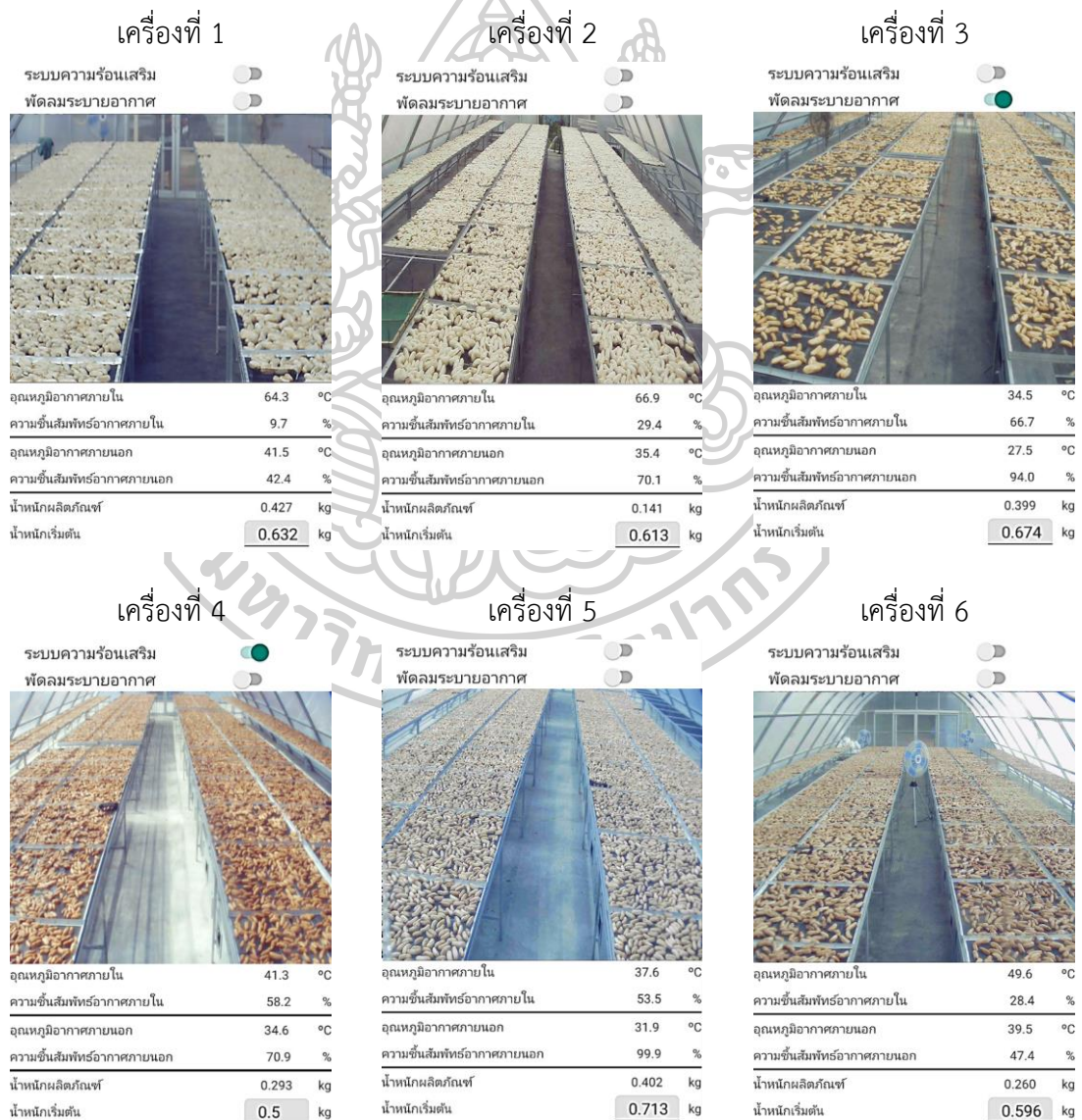
รูปที่ 63 หน้าจอโทรศัพท์มือถือที่แสดงผลสถานะการอบแห้งและแถบคำสั่งของการควบคุมสถานะการอบแห้ง
