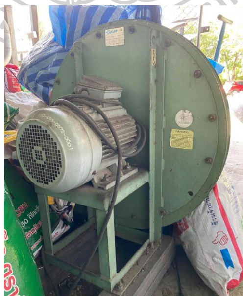
รูปที่ 3.6 พัดลมทุติยภูมิและตติยภูมิ (Secondary and tertiary blower)
