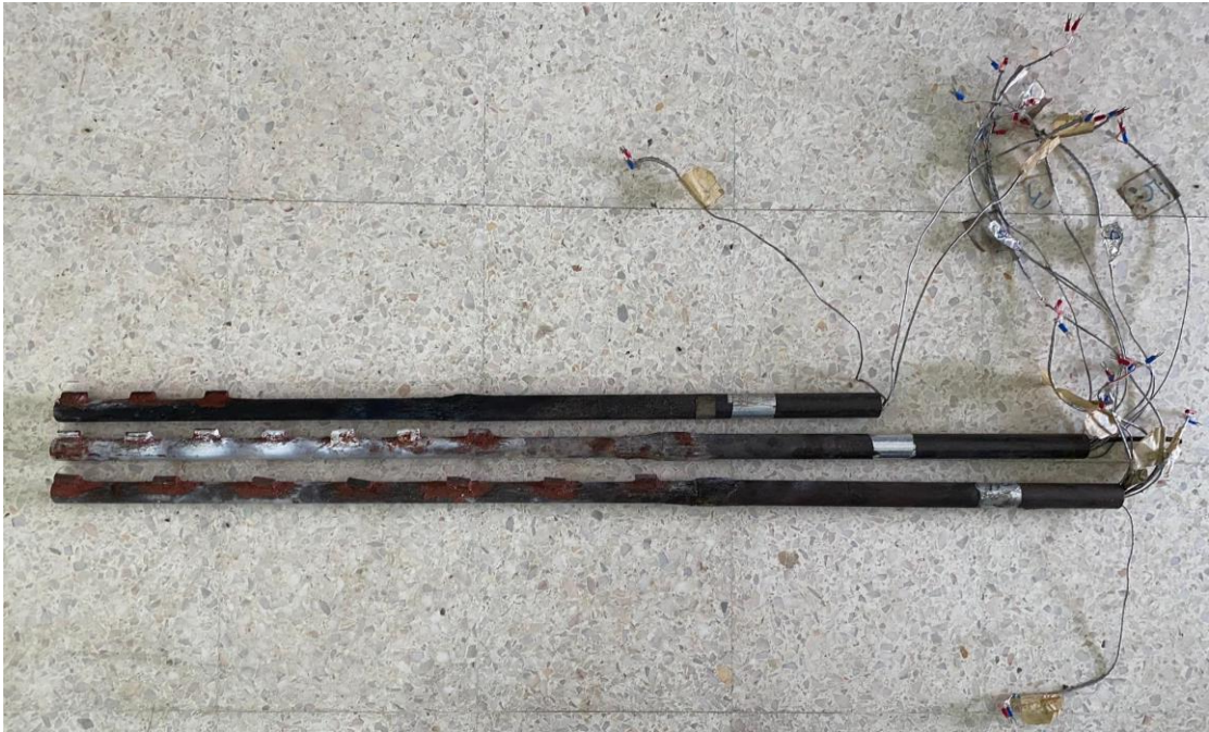
รูปที่ 3.12 อุปกรณ์ที่ใช้ในการหาค่าสัมประสิทธิ์การถ่ายเทความร้อน [18]
