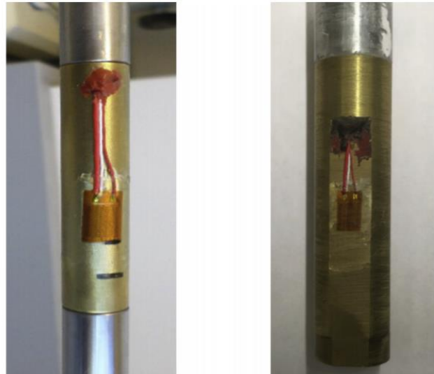
รูปที่ 2.26 อุปกรณ์วัดค่าสัมประสิทธิ์การถ่ายเทความร้อนโดยใช้ MicroFoil™ heat transfer sensor ขนาดเส้นผ่านศูนย์กลางของอุปกรณ์การวัด (ก) 0.0127 m (ข) 0.0254 m [28]
