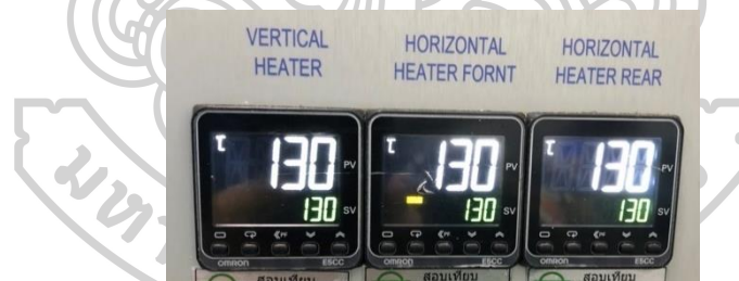
ภาพที่ 45 ตั้งค่าระดับปัจจัยอุณหภูมิในการซีล 130 °C
