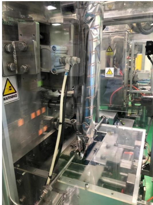
ภาพที่ 41 ชุดซีลของเครื่องบรรจุของอัตโนมัติ
