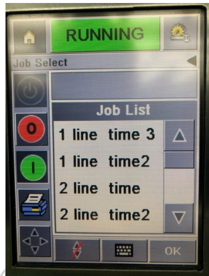
ภาพที่ 30 ก่อนปรับปรุง set code date ต้องทำการ set รายละเอียดการพิมพ์ใหม่ทุกครั้ง
