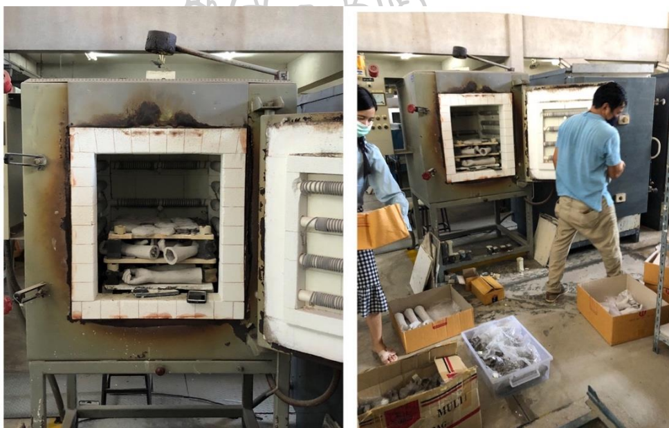
ภาพที่ 105 แสดงภาพกระบวนการเผาดินเพื่อเผาแกร่งด้วยเตาเผาไฟฟ้า อุณหภูมิ 1,200 องศา ที่มา : ถ่ายเมื่อวันที่ 25 พฤษภาคม 2564
