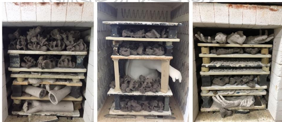
ภาพที่ 103 แสดงภาพกระบวนการเผาดินเพื่อเผาด้วยเตาเผาไฟฟ้า อุณหภูมิ 800 องศา ที่มา : ถ่ายเมื่อวันที่ 25 พฤษภาคม 2564
