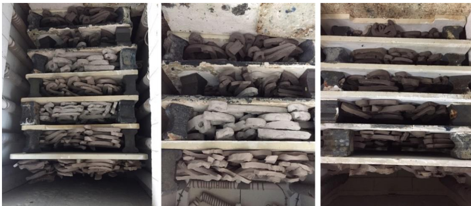
ภาพที่ 104 แสดงภาพกระบวนการเผาดินเพื่อเผาติดด้วยเตาเผาไฟฟ้า อุณหภูมิ 800 องศา ที่มา : ถ่ายเมื่อวันที่ 25 พฤษภาคม 2564
