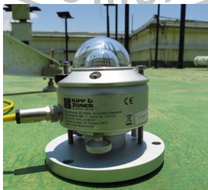
รูปที่ A.4 การประกอบไพราโนมิเตอร์เข้ากับส่วนฐานตัวนทำยกระบอกบังค้ำลำแสง
