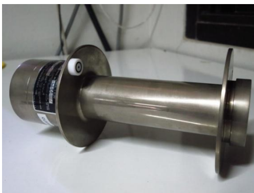
รูปที่ 3.17 ไพร่เฮริโอมิเตอร์อ้างอิงที่นำมาใช้ในระบบสอบเทียบตาม ISO 9846
