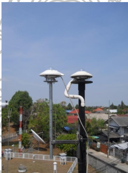
รูปที่ 2.32 การติดตั้งอุปกรณ์ในการสอบเทียบไพราโนมิเตอร์ภาคสนาม
