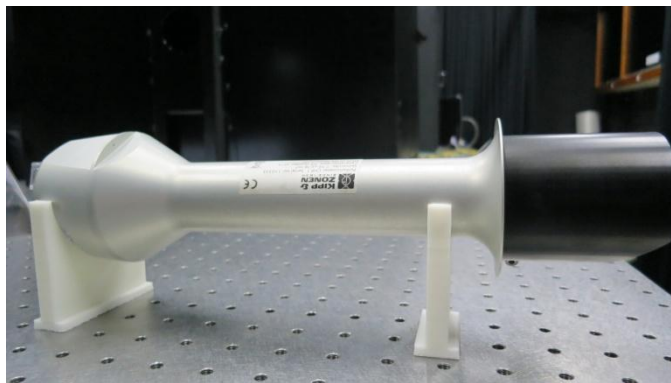
รูปที่ 2.17 ไพร่เฮริโอมิเตอร์แบบเทอร์โมไพล์ รุ่น CHP1 ที่ผลิตโดยบริษัท Kipp&Zonen
