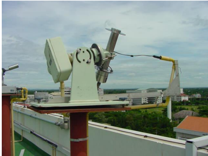
รูปที่ 2.19 อุปกรณ์ติดตามการเคลื่อนที่ของดวงอาทิตย์แบบขับเคลื่อนอัตโนมัติแกนเดียว
