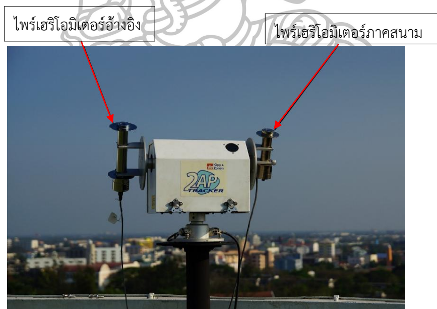
รูปที่ 2.28 การติดตั้งอุปกรณ์การสอบเทียบไพร์เฮริโอมิเตอร์ภาคสนามที่ศูนย์สอบเทียบเครื่องวัดรังสีอาทิตย์ มหาวิทยาลัยศิลปากร
