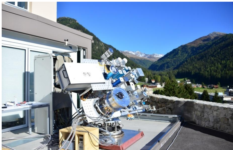
รูปที่ 2.25 เครื่องวัดรังสีมาตรฐานของศูนย์รังสีโลก (WRC) ที่เมืองดาวอส ประเทศสวิสเซอร์แลนด์
