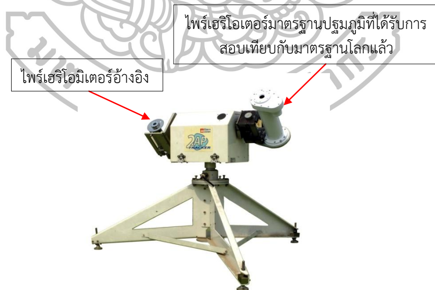
รูปที่ 2.27 การติดตั้งอุปกรณ์สำหรับสอบเทียบไพร์เฮลิโอมิเตอร์อ้างอิงที่ศูนย์สอบเทียบเครื่องวัดรังสีอาทิตย์ มหาวิทยาลัยศิลปากร
