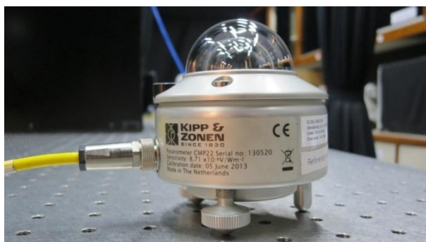
รูปที่ 3.24 ไพราโนมิเตอร์ ยี่ห้อ Kipp&Zonen รุ่น CMP22 serial no: 130520
