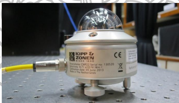
รูปที่ 3.28 ไพราโนมิเตอร์อ้างอิง ยี่ห้อ Kipp&Zonen รุ่น CMP22 serial no: 130520
