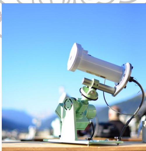
รูปที่ 2.26 ไพร์เฮริโอมิเตอร์แบบสมบูรณ์ของภาควิชาฟิสิกส์ คณะวิทยาศาสตร์ มหาวิทยาลัยศิลปากร
