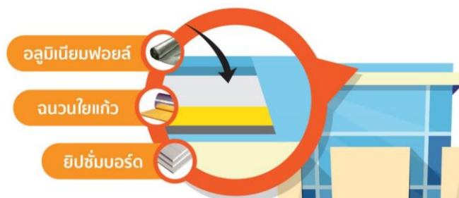
ภาพที่ 20 การติดตั้งฉนวนกันความร้อน
