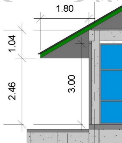
ภาพที่ 33 แสดงลักษณะแผงบังแดดจากแนวยื่นของหลังคาบริเวณชั้นบน
