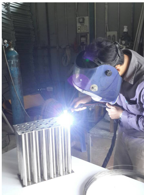
รูปที่ 3.8 การประกอบตัวแลกเปลี่ยนความร้อน
