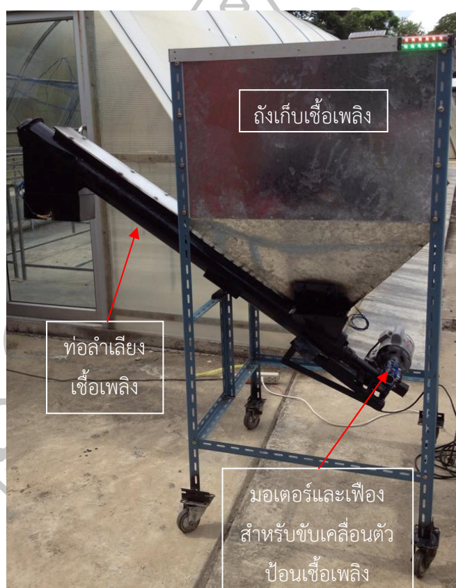
รูปที่ 3.10 ลักษณะของตัวป้อนเชื้อเพลิง
