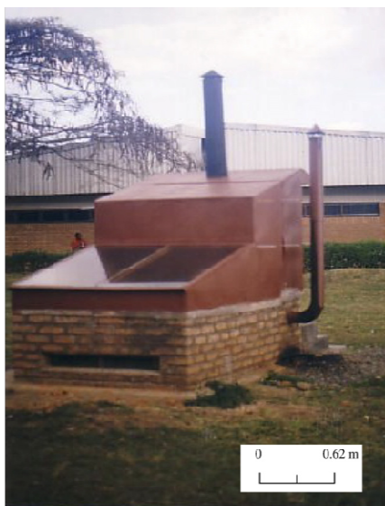
รูปที่ 2.16 ลักษณะของเครื่องอบแห้งพลังงานแสงอาทิตย์ที่พัฒนาโดย Madhlopa และ Ngwalo (2007)
