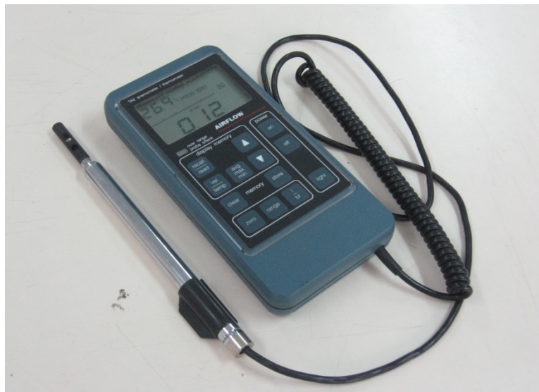
รูปที่ 3.18 เครื่องวัดความเร็วลมแบบ hot wire ยี่ห้อ Airflow รุ่น TA5
