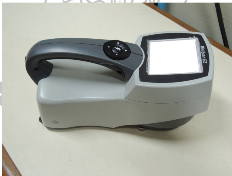
รูปที่ 3.23 เครื่องวัดสียี่ห้อ Hunter Lab รุ่น MiniScan EZ
