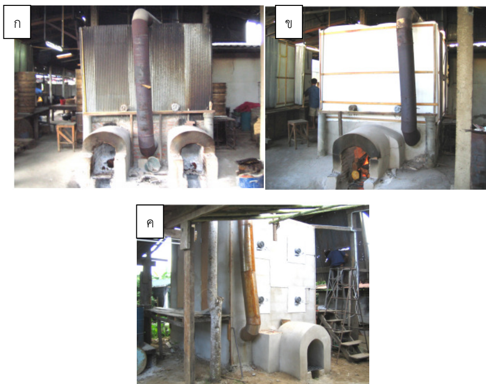
รูปที่ 2.15 ก. เครื่องอบแห้งลำไยแบบพื้นบ้าน (ผนังทำจากสังกะสี) ข. เครื่องอบแห้งที่ผนังทำด้วยกระเบื้องแผ่นเรียบและบุด้วยฉนวนโพลีเอทิลีน และ ค. เครื่องอบแห้งที่ผนังคอนกรีตบล็อกฉาบปูน (ทวีชัย นิมาแสง และณัฐวุฒิ เนียมสอน, 2010)
