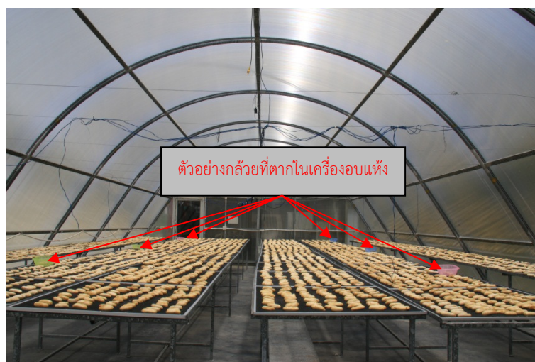
รูปที่ 3.25 กล้วยน้ำว้าในเครื่องอบแห้งพลังงานแสงอาทิตย์แบบพาราโบลาโดม
