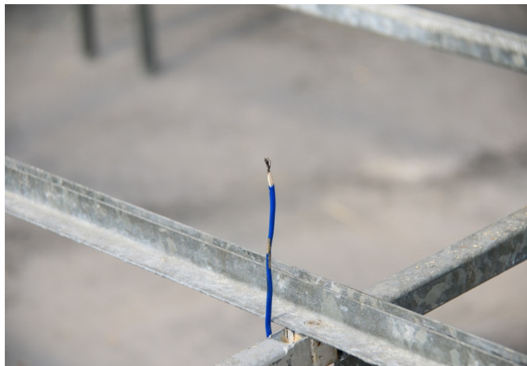
รูปที่ 3.16 สายเทอร์โมคัปเปิลชนิดเค (K-type thermocouple) สำหรับวัดอุณหภูมิ
