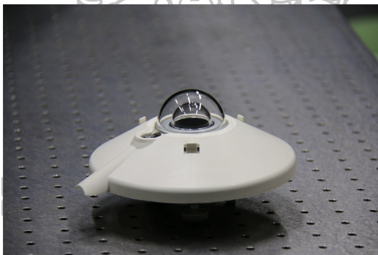
รูปที่ 3.19 ไพรานอมิเตอร์ ยี่ห้อ Kipp&Zonen รุ่น CM11
