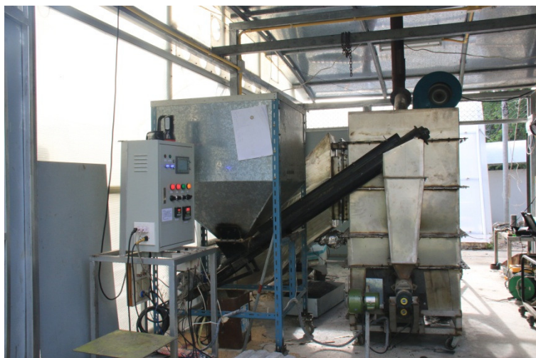
รูปที่ 3.13 ระบบทำอากาศร้อนที่ใช้แกลบเป็นเชื้อเพลิงที่พัฒนาขึ้นในงานวิจัยนี้
