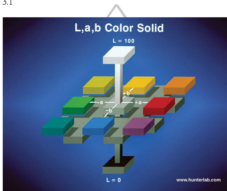
รูปที่ 3.48 แผนผังการการอ่านค่าสีของ Hunter Lab รุ่น Miniscan EZ ( L^* , a^* , b^* ) (www.hunterlab.com)
