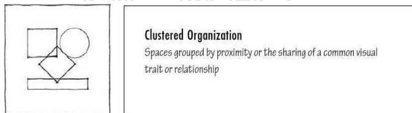
ภาพที่ 19 การรวมกลุ่มที่วางรูปแบบการจัดรวมกลุ่ม (Cluster) ที่มา : http://www.cccarchitecture.org/122readingsfa16
