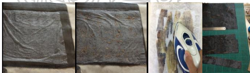
ภาพที่ 119 การรีดอัดวัสดุแผ่นเปลือกข้าวโพดรูปแบบแผ่น
