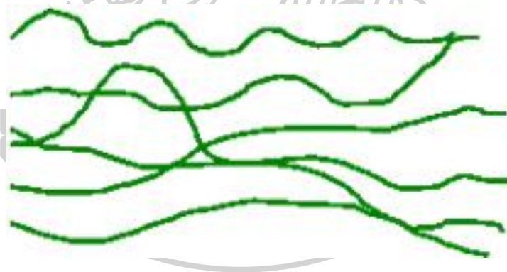
ภาพที่ 22 จำลองโครงสร้างสายยาวๆของพอลิเมอร์ของพลาสติกจำพวกเทอร์โมพลาสติก (Thermoplastics)
