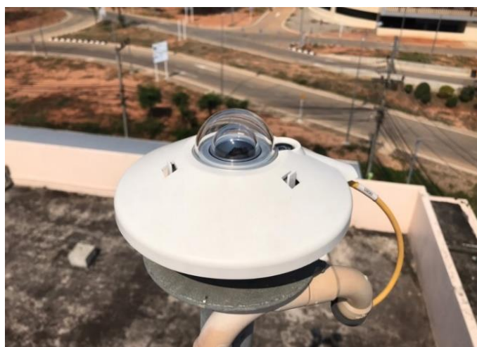
รูปที่ 10 เครื่องวัดรังสีรวมจากดวงอาทิตย์แบบเทอร์โมไพล์หรือไพราโนมิเตอร์แบบเทอร์โมไพล์
