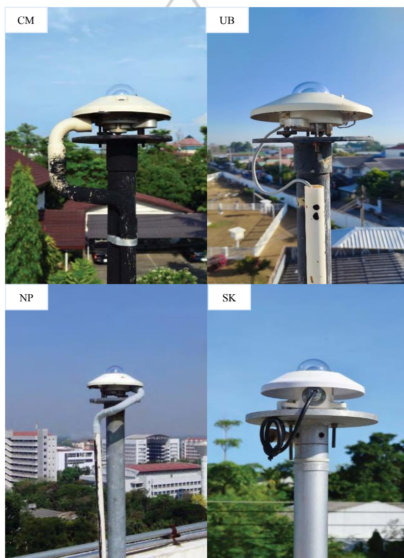
รูปที่ 92 เครื่องวัดรังสีรวมจากดวงอาทิตย์ที่ 4 สถานีในภูมิภาคหลักของประเทศไทย
