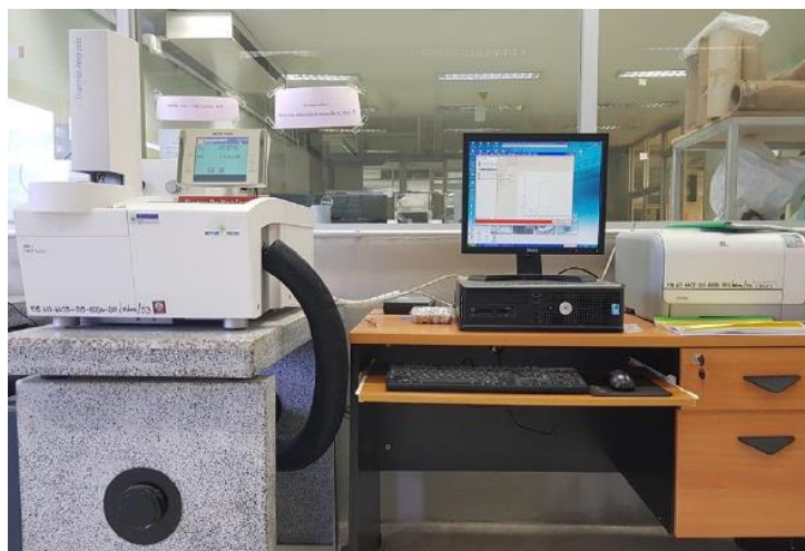
รูปที่ 3.2 แสดงเครื่อง Differential scanning calorimeter (DSC)
