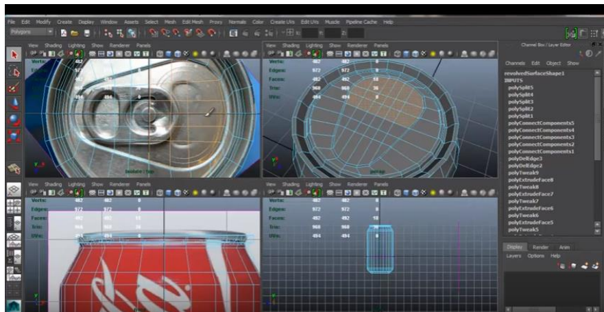
รูปที่ 2.4 แสดงการออกแบบกระป๋องเครื่องดื่มด้วยโปรแกรม Autodesk MAYA [10]
