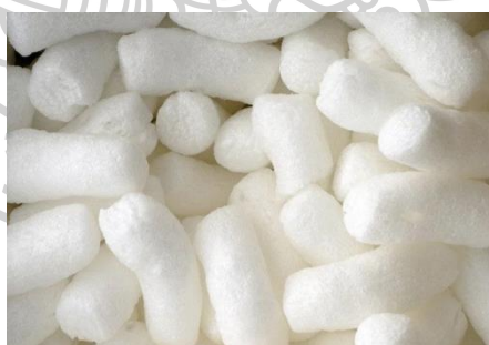
รูปที่ 2.22 แสดงรูปทรงของโฟมสไตรีนแบบ Peanuts [36]
