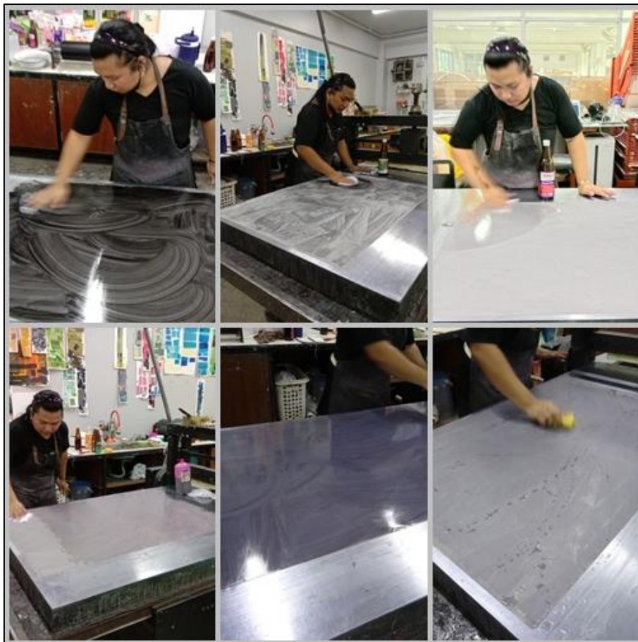
ภาพที่ 23 ภาพแสดงขั้นตอนการล้างเชมม่าดำเพื่อเตรียมความพร้อมของแม่พิมพ์สำหรับขั้นตอนการกลิ้งหมึกพิมพ์
