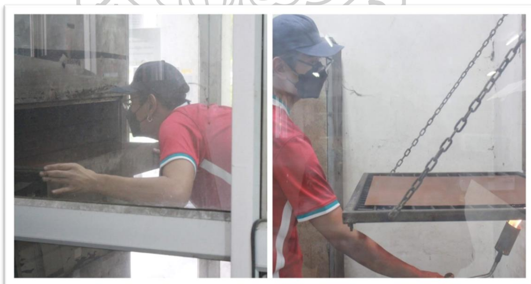
ภาพที่ 24 ภาพแสดงขั้นตอนโรยผงแอสฟัลต์และการย่างแม่พิมพ์ด้วยความร้อน
