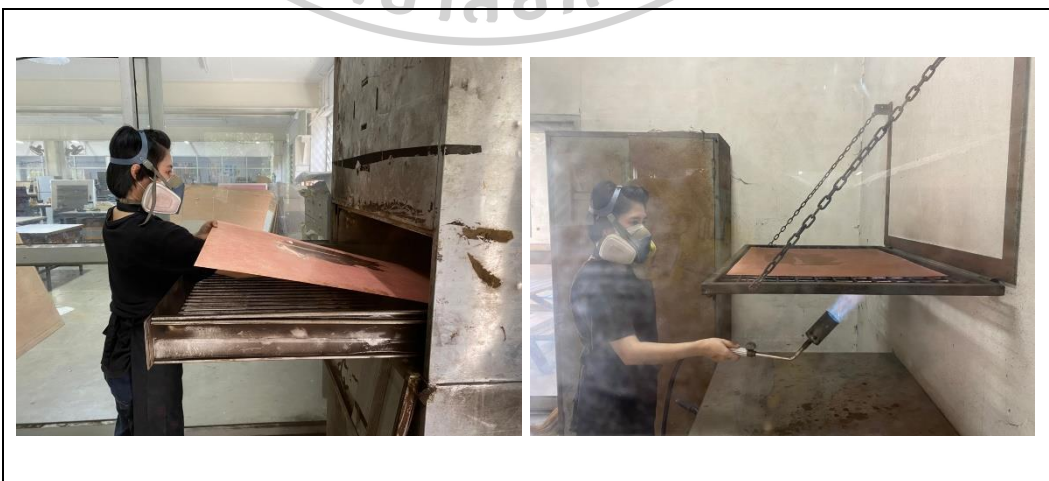
ภาพที่ 26 ภาพแสดงการวางแม่พิมพ์โรยผงแอสฟัลต์และการย่างแม่พิมพ์
