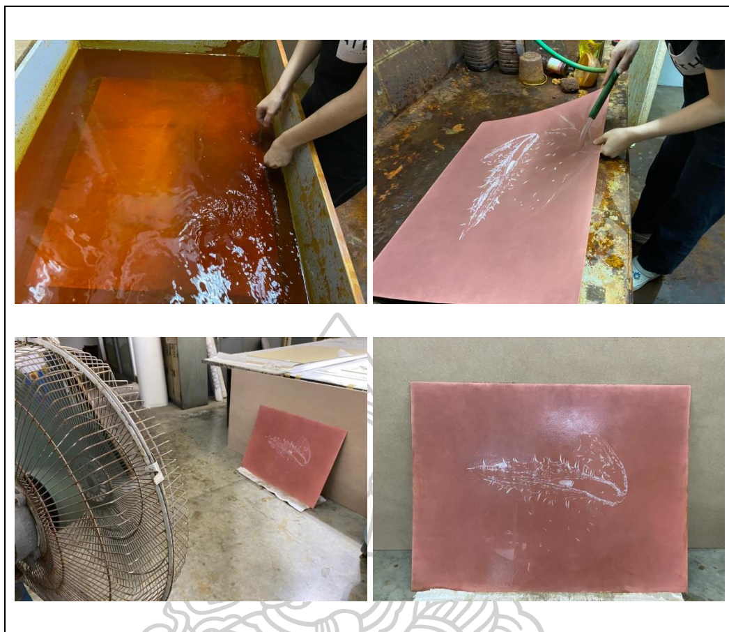
ภาพที่ 28 ภาพแสดงขั้นตอนการแช่น้ำกรด/การล้างทำความสะอาดแม่พิมพ์หลังแช่กรด/การผึ่งลมให้แห้ง
