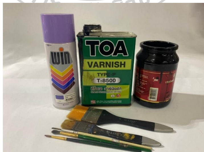
ภาพที่ 37 ภาพวัสดุอุปกรณ์ในการกัน (ฉนวน) กันน้ำกรดกัดบนผิวหน้าแม่พิมพ์
