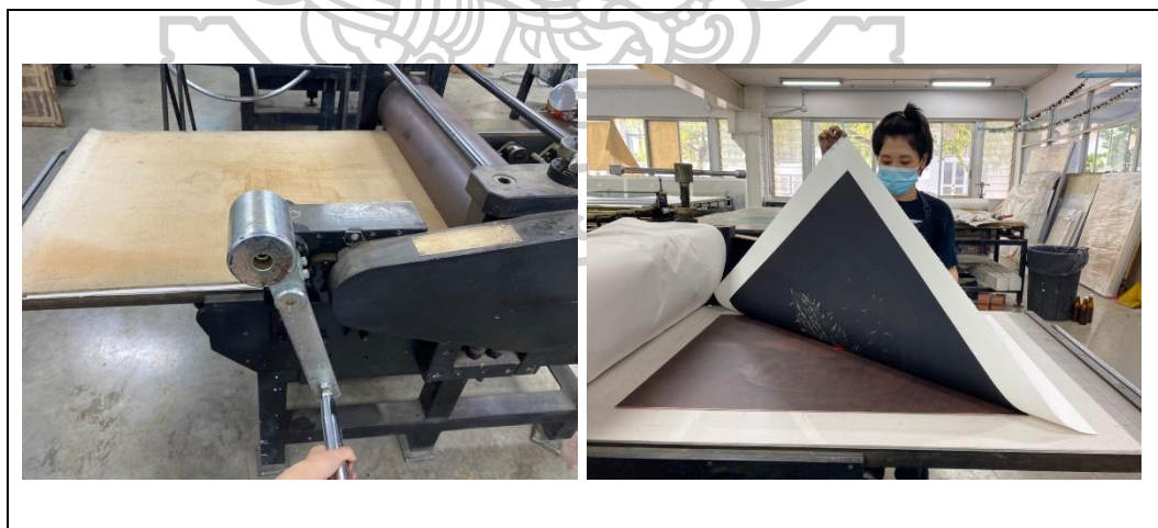
ภาพที่ 33 ภาพแสดงขั้นตอนการดึงกระดาษออกจากแม่พิมพ์หลังทำการอัดด้วยแทนพิมพ์
