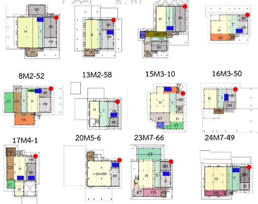
ภาพที่ 141 เรื่อนกลุ่มที่ 1 พบตำแหน่งเสาเอกของเรื่อนโดยจะวางตำแหน่งไว้ทางด้านทิศ ตะวันออกและเป็นเสาต้นแรกของหัวมุมด้านซ้ายมือของเรื่อน
