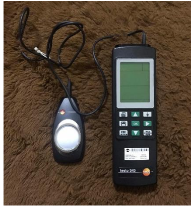
ภาพที่ 46 แสดงเครื่องมือวัดแสงลักซ์แบบพกพา รุ่น Testo 545
