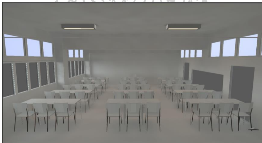
ภาพที่ 76 ลักษณะแสงสว่างหลังการปรับปรุงโดยใช้แสงธรรมชาติร่วมกับแสงประดิษฐ์ 100%
