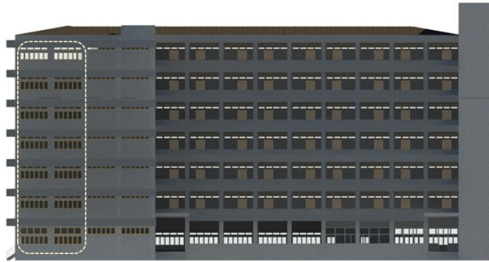
ภาพที่ 58 บริเวณที่เปลี่ยนเป็นกระจก Low-E ด้านทิศใต้
