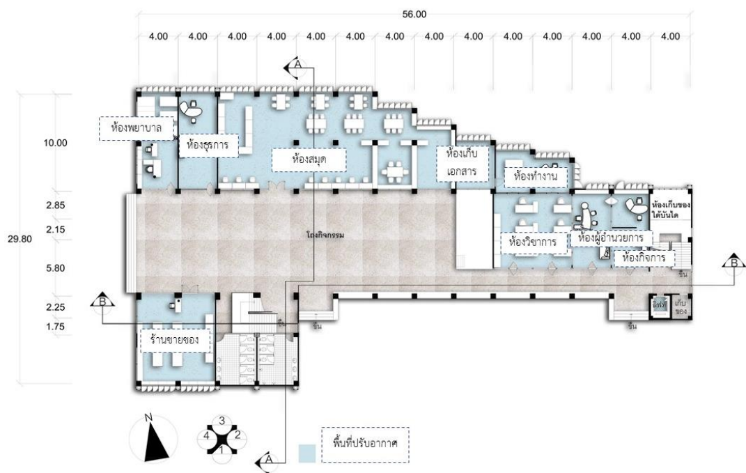
ภาพที่ 12 พื้นที่ปรับอากาศของผังพื้นที่ชั้นที่ 1
