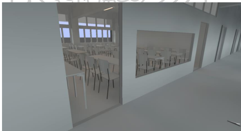
ภาพที่ 71 การเจาะช่องเปิดขนาด 1.00x3.00 m บริเวณทิศใต้ของอาคาร
