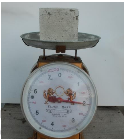
รูปที่ 122 แสดงการนำคอนกรีตทดสอบชั่งน้ำหนักก่อนทดสอบการดูดซึมน้ำ
