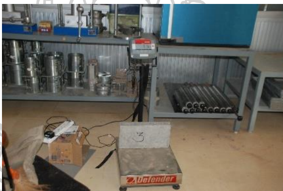
รูปที่ 158 แสดงการชั่งน้ำหนักคอนกรีตบล็อกก่อนนำไปแช่น้ำเพื่อทดสอบการดูดซึมน้ำ
