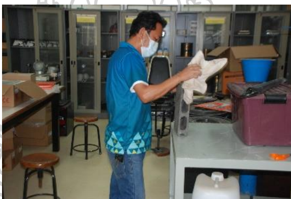
รูปที่ 161 แสดงการชั่งน้ำคอนกรีตบล็อกก่อนนำมาชั่งน้ำหนัก
