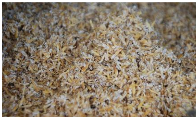
รูปที่ 80 แสดงลักษณะแกลบหลังจากการเคลือบ Coating ด้วยน้ำยางพารา
