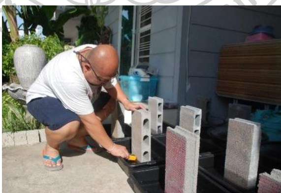
รูปที่ 175 แสดงลักษณะการวัดค่าความชื้นทุก ๆ 1 ชั่วโมงที่ผิวคอนกรีตบล็อกตลอด 24 ชั่วโมง
