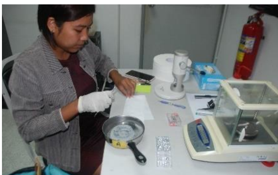
รูปที่ 58 แสดงการเตรียมทดสอบจุดหลอมเหลววัสดุเปลี่ยนสถานะ (PCM)
