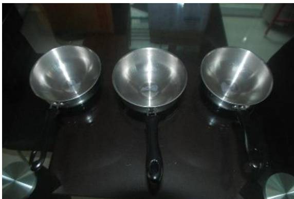
รูปที่ 47 แสดงภาชนะกระชားเพื่อหลอมเหลววัสดุเปลี่ยนสถานะ (PCM)
