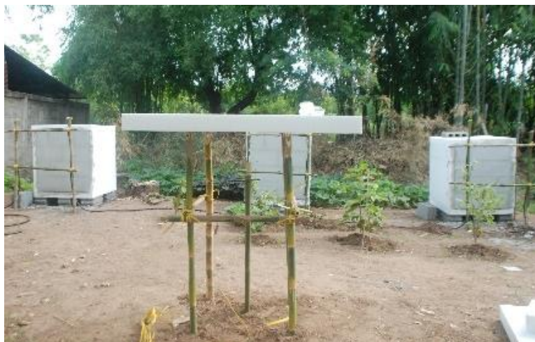
รูปที่ 190 แสดงตำแหน่งการติดตั้งเครื่องตรวจวัดอุณหภูมิและความชื้นภายนอกกล่องทดสอบ
