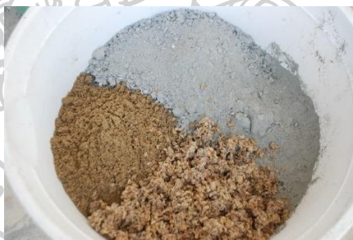
รูปที่ 125 แสดงส่วนผสมต่างๆ ก่อนผสมให้เข้ากันสำหรับขึ้นรูปก้อนคอนกรีตทดสอบ
