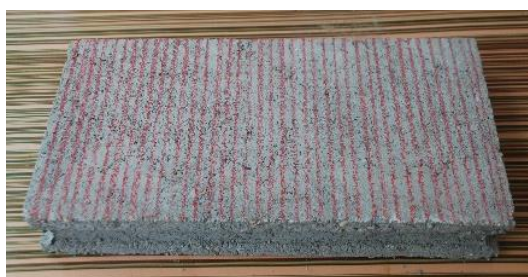
รูปที่ 170 แสดงการแบ่งเส้นชั้นคอนกรีตมีความห่างชั้นละ 1 ซม.
