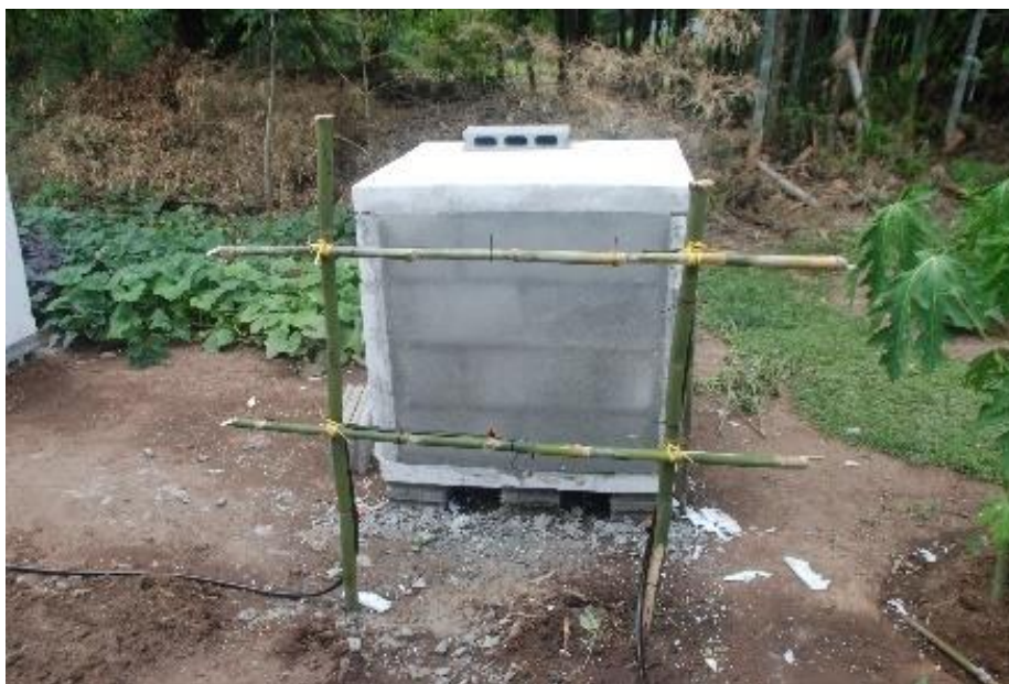
รูปที่ 180 แสดงการฉาบคอนกรีตบล็อกหน้ากล่องทดสอบ
