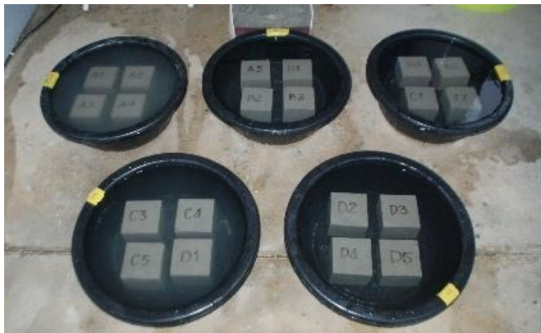
รูปที่ 120 แสดงการบ่มก้อนคอนกรีตทดสอบทั้ง 20 สูตร โดยการแช่น้ำ
