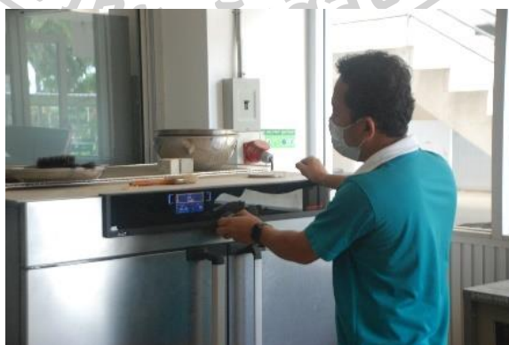
รูปที่ 156 แสดงการตั้งเวลาอบความร้อนคอนกรีตบล็อก 24 ชั่วโมง
