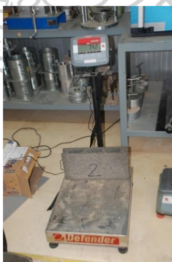
รูปที่ 162 แสดงการชั่งน้ำหนักคอนกรีตบล็อกหลังจากแช่น้ำเพื่อเปรียบเทียบกับน้ำหนักก่อนแช่น้ำ
