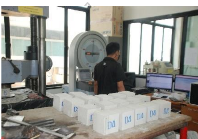
รูปที่ 133 แสดงการเตรียมก้อนคอนกรีตเพื่อทดสอบการต้านทานแรงอัด
