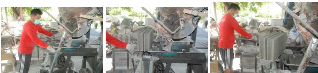
รูปที่ 141 แสดงการอัดขึ้นรูปคอนกรีตบล็อกจากแม่พิมพ์เหล็กขนาด 70 x 190 x 390 มม.
