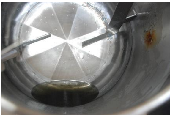
รูปที่ 96 แสดงการหลอมเหลวส่วนผสมต่างๆในเครื่องผสม (Mixing)
