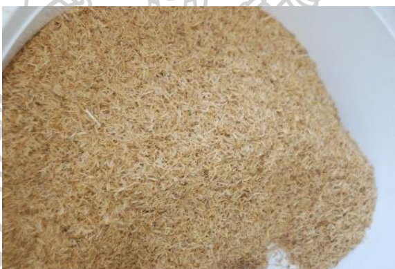
รูปที่ 75 แสดงลักษณะแกลบที่เซ็ดตัวแล้วหลังจากเคลือบด้วยวัสดุเปลี่ยนสถานะ (PCM)
