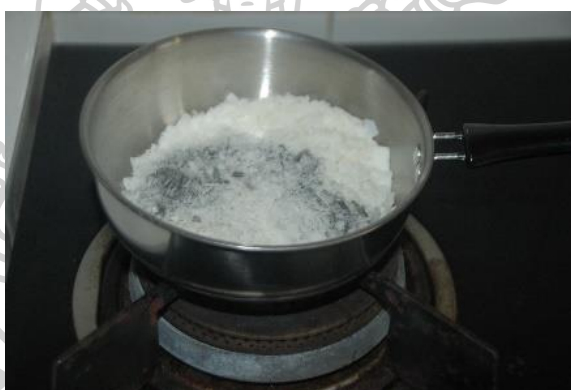
รูปที่ 54 แสดงการหลอมเหลวส่วนผสมระหว่างวัสดุเปลี่ยนสถานะ (PCM) และผงตะไบเหล็ก (Iron Powder)
