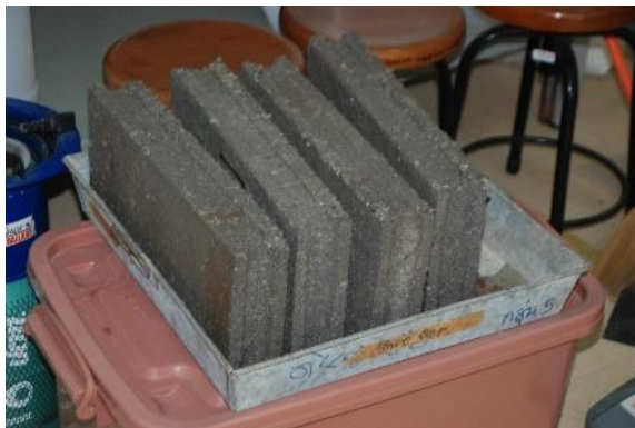
รูปที่ 160 แสดงการนำคอนกรีตขึ้นจากน้ำนำมาพักไว้
