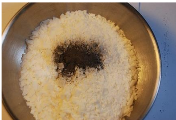
รูปที่ 53 แสดงส่วนผสมระหว่างวัสดุเปลี่ยนสถานะ (PCM) และผงตะไบเหล็ก (Iron Powder)
