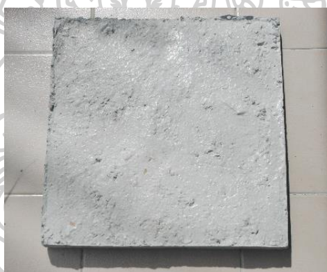
รูปที่ 169 แสดงลักษณะก้อนคอนกรีตทดสอบเพื่อส่งทดสอบคุณสมบัติในการนำความร้อน (k value)
