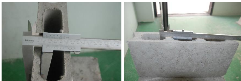
รูปที่ 148 แสดงการวัดขนาดหนาของเปลือกก้อนคอนกรีตบล็อก
