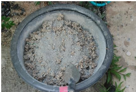
รูปที่ 165 แสดงการชั่งตวงส่วนผสมตามสูตรที่ขึ้นรูปคอนกรีตบล็อกจริง
