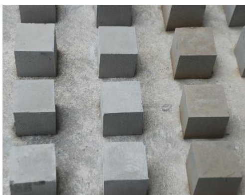
รูปที่ 132 แสดงลักษณะก้อนคอนกรีตที่จะนำไปทดสอบการต้านทานแรงอัด
