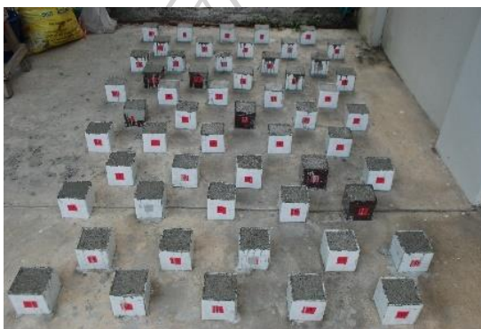
รูปที่ 128 แสดงการนำคอนกรีตที่ผสมแล้วใส่ในแม่พิมพ์
