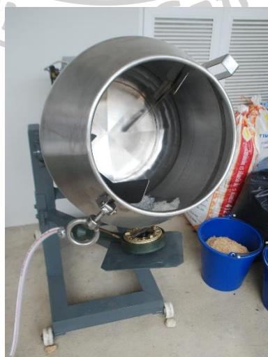
รูปที่ 70 แสดงเครื่องผสม (Mixing) ที่สามารถปรับลดอุณหภูมิได้
