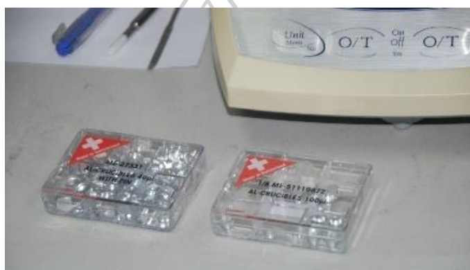
รูปที่ 60 แสดงลักษณะภาชนะทดสอบจุดหลอมเหลว (PAN)
