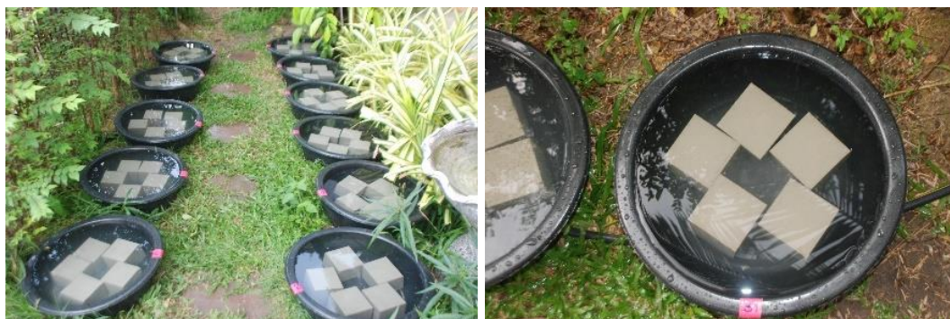
รูปที่ 130 แสดงการนำคอนกรีตทดสอบแช่น้ำเป็นเวลา 3 วัน
