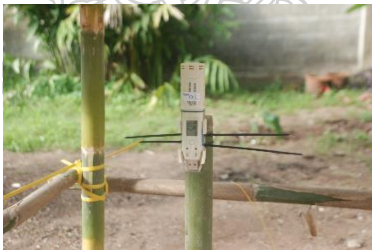
รูปที่ 191 แสดงการติดตั้งเครื่องตรวจวัดอุณหภูมิและความชื้นภายนอกกล่องทดสอบแล้ว รูปที่ 192เสร็จ
