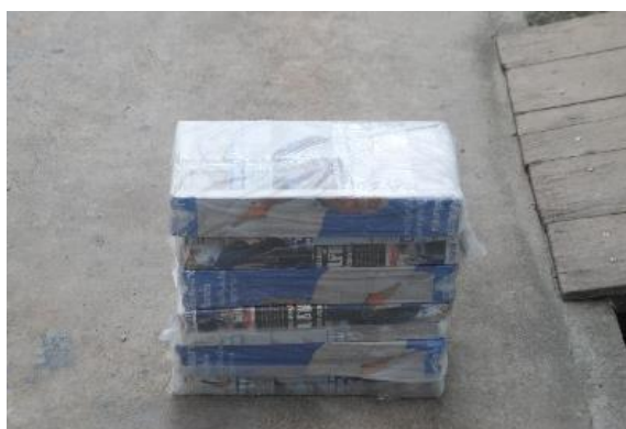
รูปที่ 143 แสดงการนำคอนกรีตบล็อกไปบ่มขึ้น 3 วันและหุ้มคอนกรีตบล็อก
