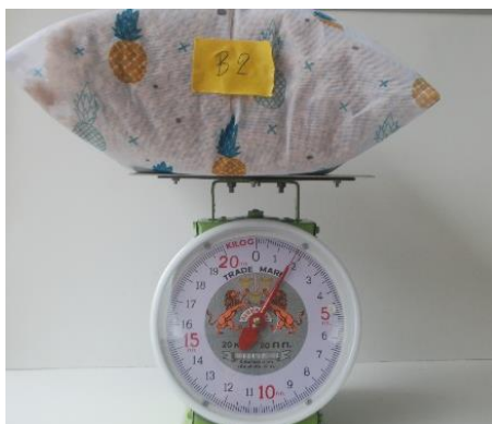
รูปที่ 85 แสดงการชั่งน้ำหนักเปลือกกะลาจากแพที่เคลือบ Coating ด้วยน้ำยางพาราบรรจุถุงโปรง
