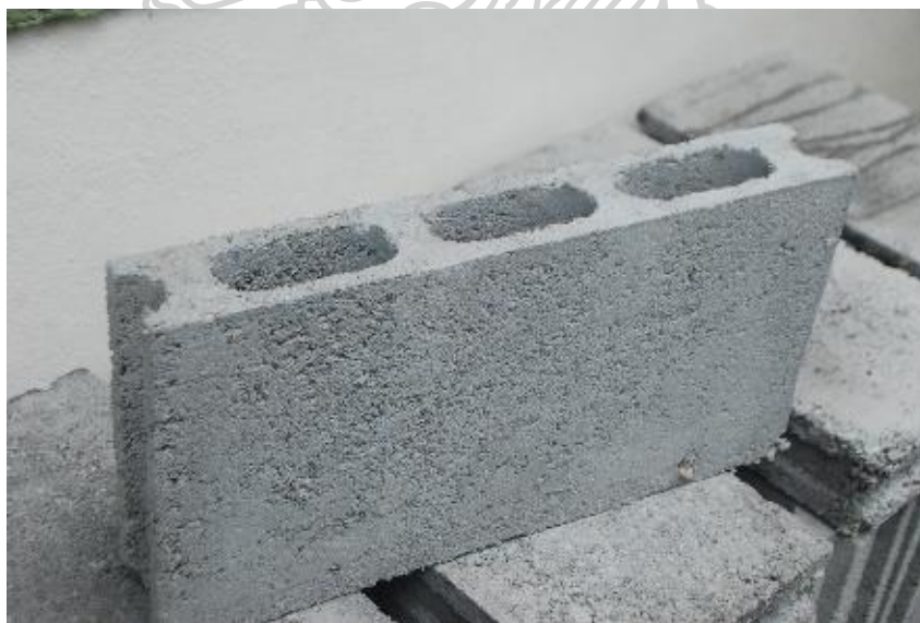
รูปที่ 145 แสดงลักษณะก้อนคอนกรีตบล็อกจริงเพื่อนำไปทดสอบในงานวิจัยขั้นต่อไป
