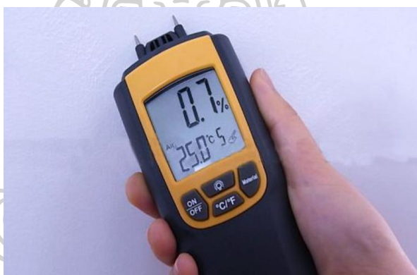
รูปที่ 174 แสดงเครื่องทดสอบความชื้น Moisture Meter รุ่น MM05-2 ยี่ห้อ Richmoto
