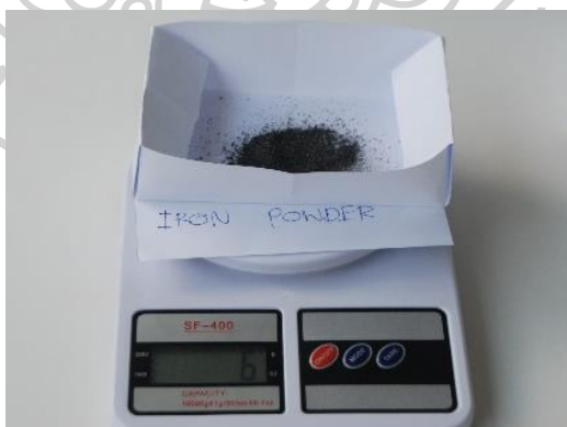
รูปที่ 95 แสดงการชั่งผงตะไบเหล็ก (Iron Powder) ตามสูตรที่ผ่านการทดสอบ
