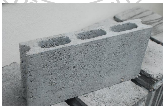
รูปที่ 208 แสดงคอนกรีตบล็อกจริงขนาด 70 x 190 x 390 มม. ที่ผลิตได้
