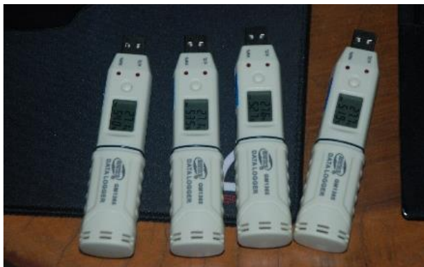
รูปที่ 187 แสดงเครื่องตรวจวัดอุณหภูมิและความชื้นยี่ห้อ BENETECH รุ่น GM 1365
