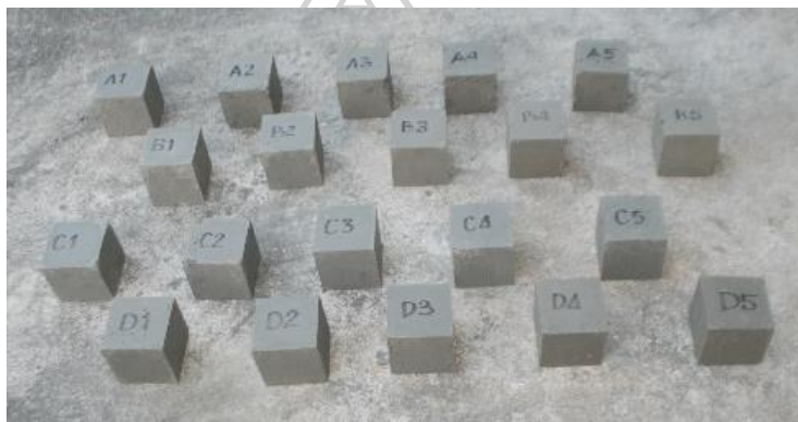
รูปที่ 203 แสดงก้อนทดสอบคอนกรีตบล็อก 20 สูตร
