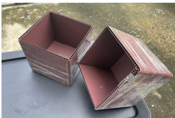
รูปที่ 108 แสดงลักษณะแม่แบบคอนกรีตทดสอบขนาด 10 x 10 x 10 ซม.
