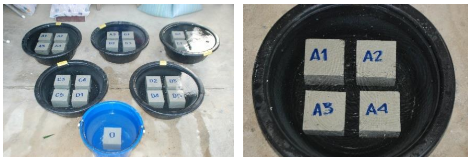
รูปที่ 124 แสดงการนำคอนกรีตทดสอบแช่น้ำเป็นเวลา 24 ชั่วโมง
