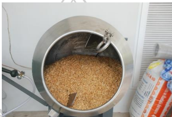
รูปที่ 97 แสดงการเคลือบ Coating วัสดุธรรมชาติด้วยวัสดุเปลี่ยนสถานะ (PCM) ในเครื่องผสม (Mixing)
