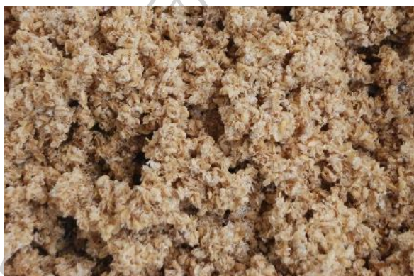
รูปที่ 81 แสดงลักษณะเปลือกกะลาที่เคลือบหลังจากการเคลือบ Coating ด้วยน้ำยางพารา
