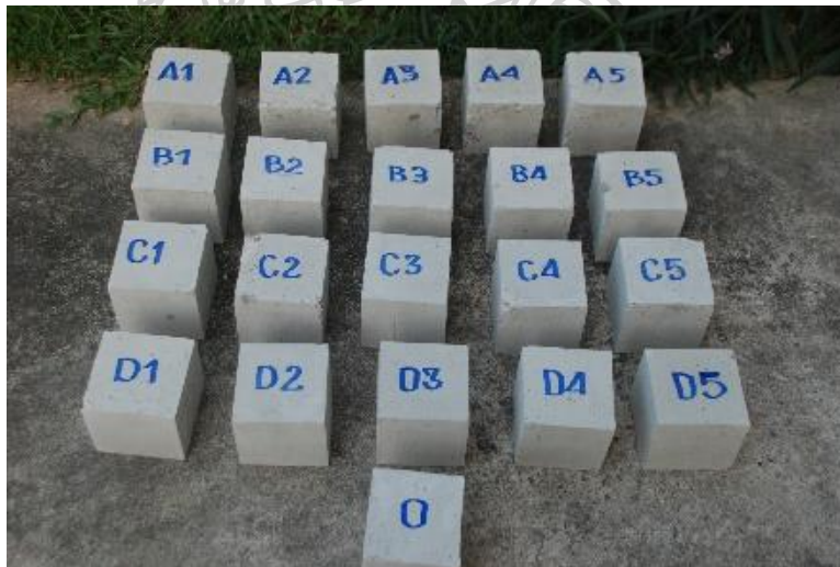
รูปที่ 121 แสดงลักษณะการผึ่งลมก้อนคอนกรีตทดสอบที่ผ่านการบ่มน้ำ 3 วัน
