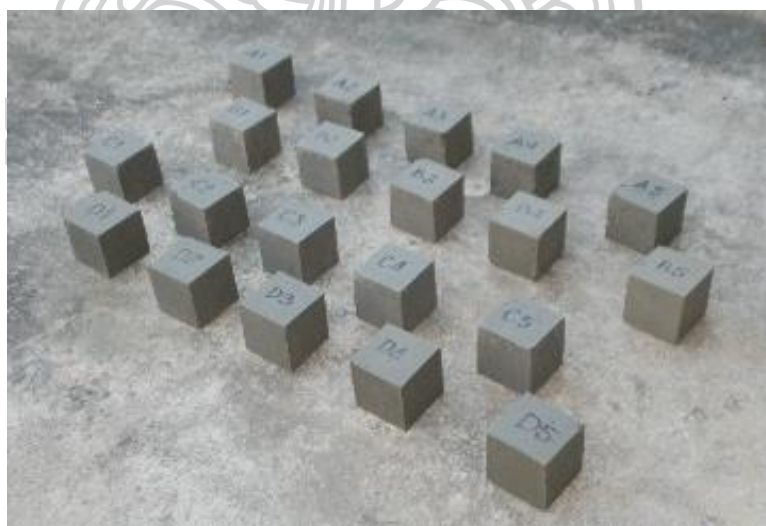
รูปที่ 119 แสดงลักษณะของก้อนคอนกรีตทดสอบหลังถอดออกจากแม่พิมพ์
