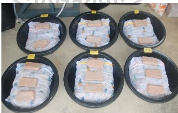
รูปที่ 87 แสดงการนำก้อนอิฐมาทับถุงโปรงเพื่อให้แช่น้ำได้ทุกส่วน
