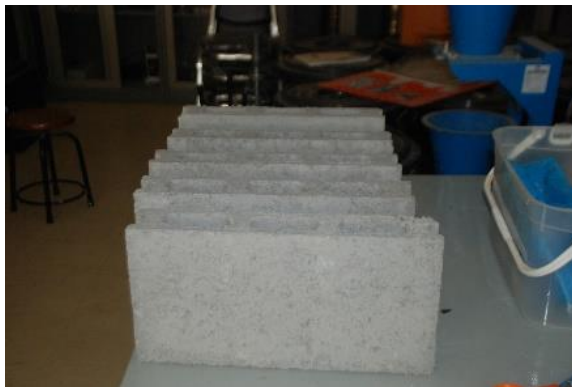
รูปที่ 157 แสดงการนำคอนกรีตบล็อกออกจากตู้อบนำมาพักไว้ให้เย็น
