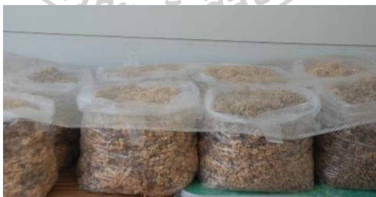
รูปที่ 107 แสดงลักษณะการจัดเก็บวัสดุธรรมชาติในร่มป้องกันความร้อนเพื่อนำไปใช้เป็นส่วนผสมคอนกรีตบล็อก
