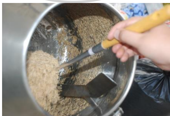
รูปที่ 73 แสดงการนำวัสดุธรรมชาติ (แกลบและเปลือกกะลาเผา) คลุกเคล้าในเครื่องผสม (Mixing)
