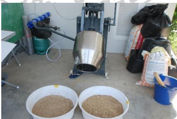
รูปที่ 82 แสดงลักษณะการเทวัสดุธรรมชาติหลังจากการเคลือบ Coating ด้วยน้ำยางพารา
