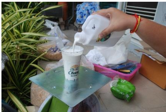
รูปที่ 77 แสดงการชั่งตวงน้ำยางพารา ก่อนนำไปเคลือบ Coating วัสดุธรรมชาติ
