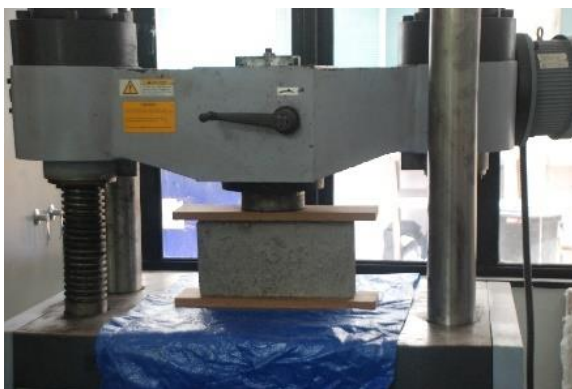
รูปที่ 151 แสดงการเริ่มต้นเครื่องกดก้อนทดสอบคอนกรีตบล็อก
