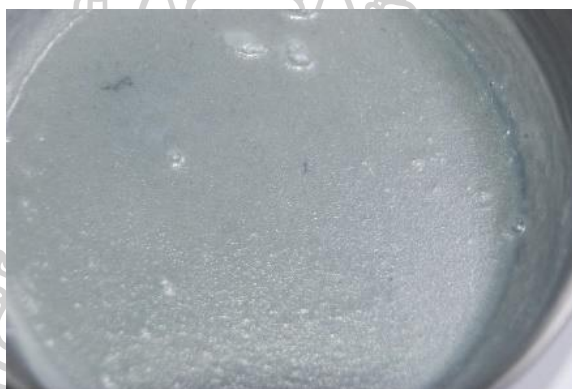
รูปที่ 57 แสดงลักษณะวัสดุเปลี่ยนสถานะ (PCM) หลังจากเซ็ตตัว
