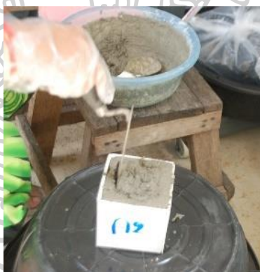
รูปที่ 116 แสดงการนำส่วนผสมที่ผสมเสร็จแล้วใส่ในแม่แบบคอนกรีตทดสอบขนาด 10 x 10 x 10 ซม.
