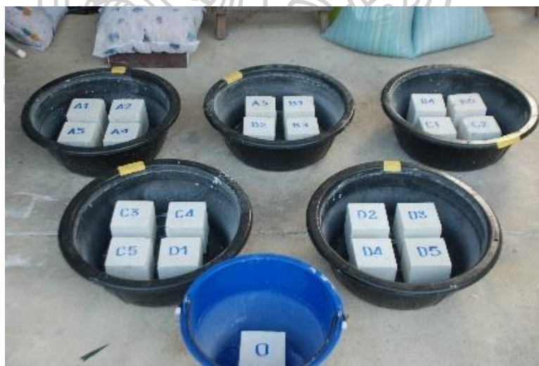
รูปที่ 123 แสดงลักษณะการเตรียมคอนกรีตก่อนการทดสอบการดูดซึมน้ำ
