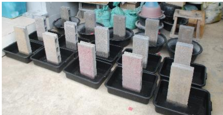
รูปที่ 173 แสดงการนำคอนกรีตบล็อกตั้งขึ้นแช่น้ำลึก 2 ซม.
