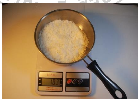
รูปที่ 52 แสดงการชั่งน้ำหนักวัสดุเปลี่ยนสถานะ (PCM)
