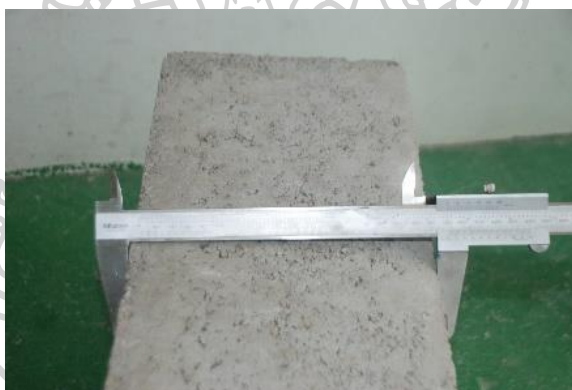
รูปที่ 146 แสดงการวัดขนาดความกว้างและความยาวของก้อนคอนกรีตบล็อก
