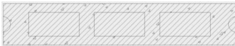
รูปที่ 210 แสดงพื้นที่หน้าตัดรวมคอนกรีตบล็อกกลวง
