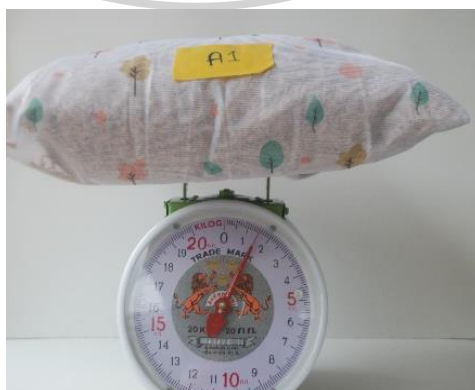
รูปที่ 84 แสดงการชั่งน้ำหนักแบบที่เคลือบ Coating ด้วยน้ำยางพาราบรรจุถุงโป่ง
