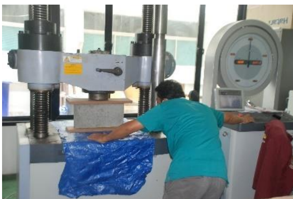
รูปที่ 150 แสดงการนำคอนกรีตบล็อกเข้าเครื่องทดสอบความต้านทานแรงอัด
