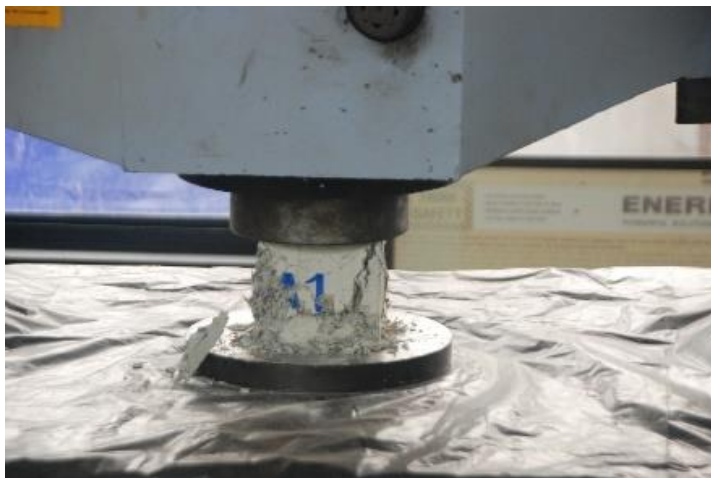
รูปที่ 135 แสดงการกดก้อนทดสอบด้วยเครื่องอัดไฮดรอลิก Compressive Strength จนกราฟแสดงผลความต้านทานเริ่มลดลง
