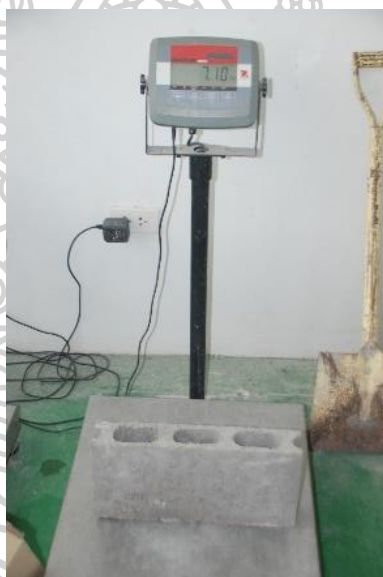
รูปที่ 149 แสดงการชั่งน้ำหนักของก้อนคอนกรีตบล็อก
