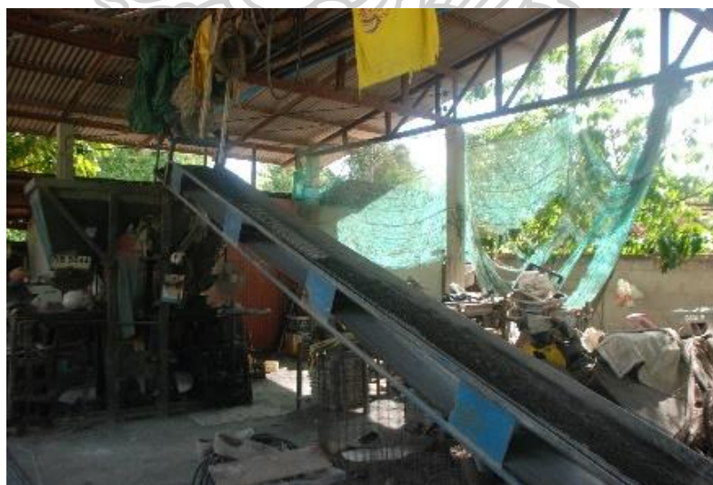
รูปที่ 140 แสดงการลำเลียงส่วนผสมขึ้นสายพานเพื่อเตรียมเข้าเครื่องอัดคอนกรีตบล็อก
