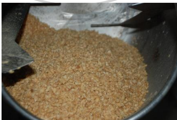
รูปที่ 76 แสดงลักษณะเปลือกกะลาที่เซ็ดตัวแล้วหลังจากเคลือบด้วยวัสดุเปลี่ยนสถานะ (PCM)
