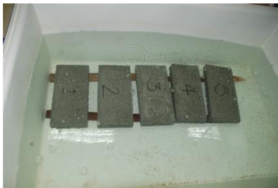
รูปที่ 159 แสดงลักษณะก้อนคอนกรีตบล็อกหลังแช่น้ำครบ 24 ชั่วโมง
