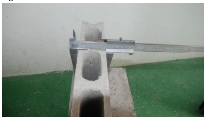
รูปที่ 147 แสดงการวัดขนาดหนาของก้อนคอนกรีตบล็อก
