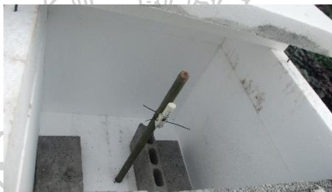
รูปที่ 188 แสดงตำแหน่งการติดตั้งเครื่องตรวจวัดอุณหภูมิและความชื้น
