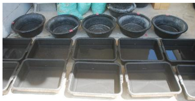
รูปที่ 172 แสดงภาชนะในการทดสอบการดูดซึมความชื้น
