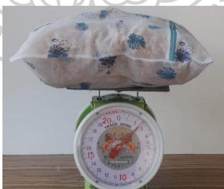
รูปที่ 90 แสดงการชั่งน้ำหนักวัสดุวิศวกรรมชาติในถุงโปร่งทุก 1 ชั่วโมงเป็นเวลา 24 ชั่วโมง
