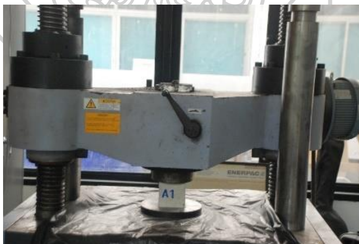
รูปที่ 134 แสดงการนำก้อนทดสอบเข้าเครื่องอัดไฮดรอลิก Compressive Strength
