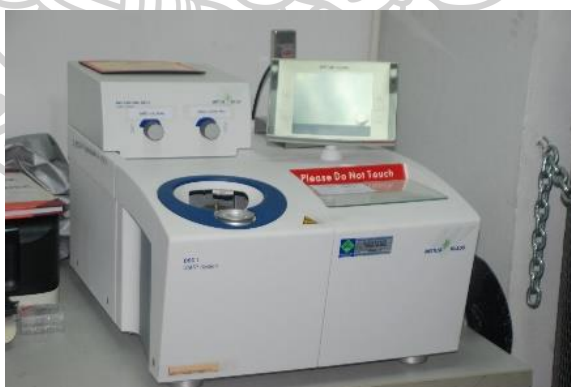
รูปที่ 61 แสดงการนำภาชนะทดสอบ (PAN) ที่บรรจุวัสดุเปลี่ยนสถานะ (PCM) เข้าเครื่องทดสอบ DSC
