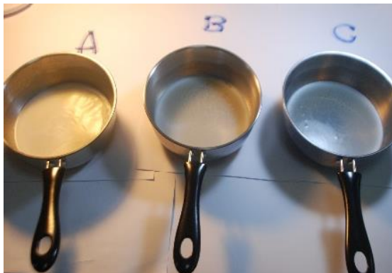
รูปที่ 56 แสดงการปล่อยให้วัสดุเปลี่ยนสถานะ (PCM) เซ็ตตัวเป็นเวลา 24 ชั่วโมง
