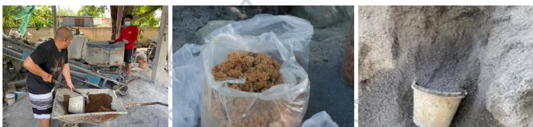
รูปที่ 137 การเตรียมส่วนผสมเพื่อขึ้นก้อนคอนกรีตบล็อกจริงขนาด 70 x 190 x 390 มม.
