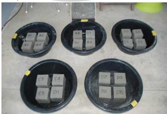
รูปที่ 204 แสดงการนำก้อนทดสอบคอนกรีตบล็อกทดสอบการดูดซึมน้ำ 24 ชั่วโมง
