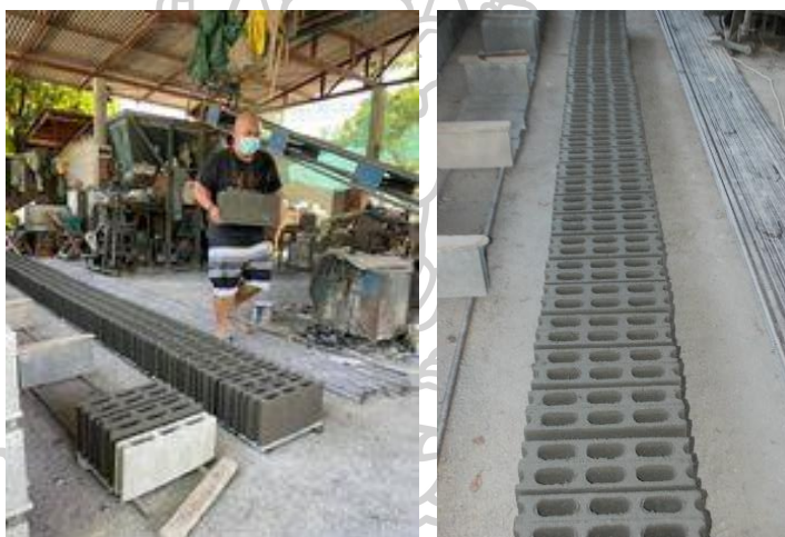
รูปที่ 142 แสดงการนำคอนกรีตบล็อกออกจากแม่พิมพ์นำไปผึ่งลม
