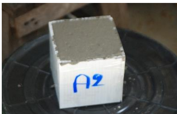
รูปที่ 117 แสดงการกระทุ้งให้แน่นและฉาบผิวก้อนคอนกรีตให้เรียบ
