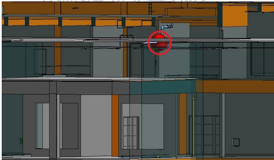
ภาพที่ 118 ตัวอย่างภาพที่ 2 ผลลัพธ์จากการใช้งานปุ่มชื่อ “Check Pipe Sleeve Element” ลักษณะสัญลักษณ์ของทรงกลม (Sphere)
