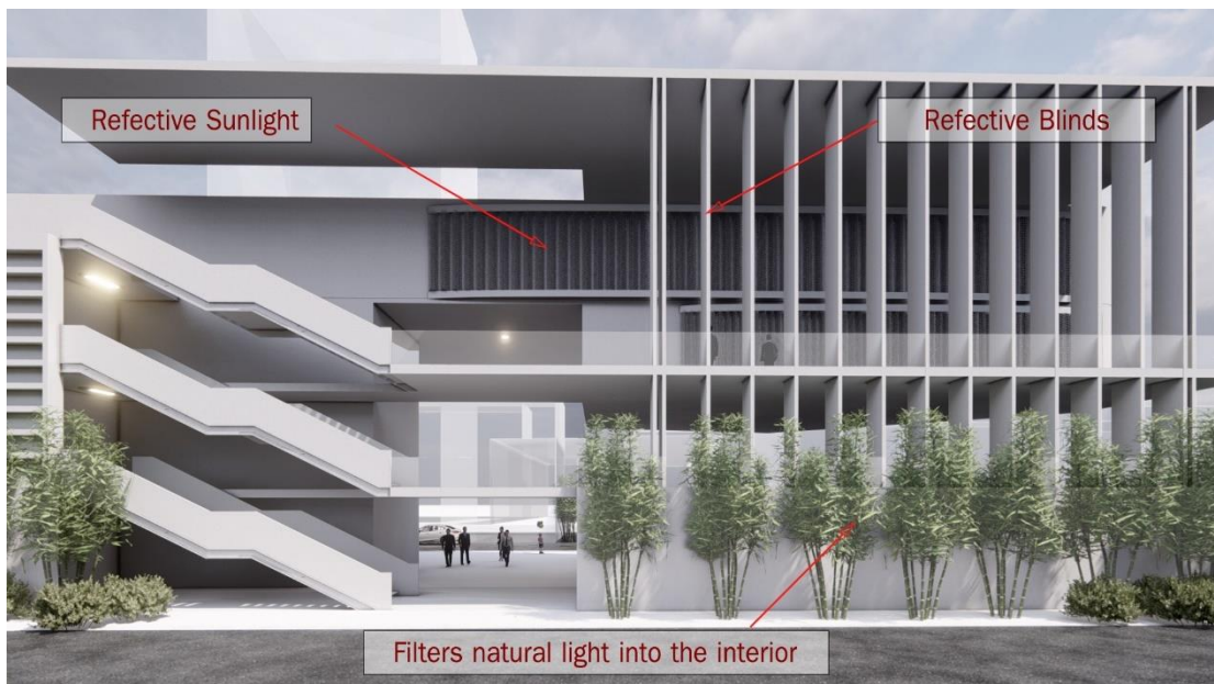
รูปภาพที่ 147 : แสดงผลลัพธ์ในการออกแบบจากสมมุติฐานของสถาปัตยกรรมต้นแบบ 2 โปรแกรม M (กลางวัน) แสดงถึงความสัมพันธ์ของผิวและเปลือกอาคารต่อแสงและลมในช่วงเวลากลางวัน ที่มา : ผู้วิจัย
