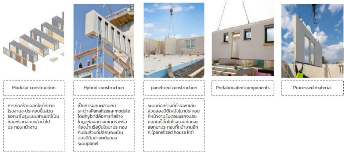
ตารางที่ 11 แสดงรูปแบบการก่อสร้างที่เป็นไปได้ของMetabolism Architecture
