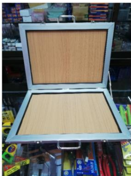
ภาพที่ 125 กลไกและวิธีการใช้งานของแผงขายสลากกินแบ่งที่ใช้เพียงบานพับและโซ่คล้องซึ่งเป็นวัสดุที่มีราคาถูกและหาได้ง่ายตามท้องตลาด นอกจากนี้ยังมีวิธีการใช้งานที่เข้าใจง่าย จัดทำโดย วรธรโรทัย ชาติประภาชัย
