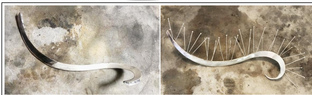
ภาพที่ 93 ตัวโครงของเครื่องประดับส่วนมือ ช้าย - การตัดแพทเทิร์นรูปตะขอขนาดใหญ่ 2 ชิ้น และนำมาเชื่อมเป็นตัวโครง ขวา - การเชื่อมประกอบชิ้นส่วนระหว่างเตี้ยเข้ากับตัวโครง
