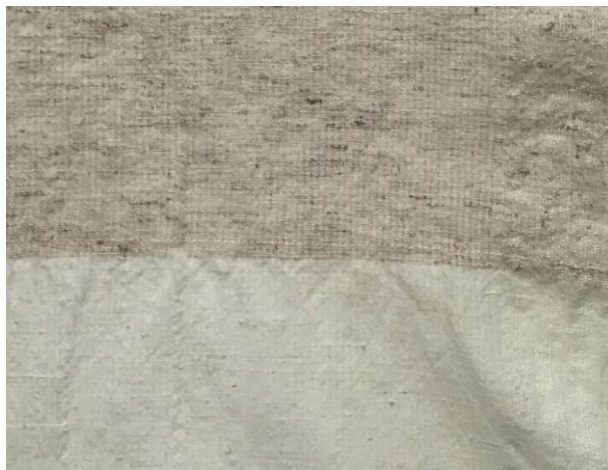
ภาพที่ 43 : แสดงภาพการทดลองทอแบบเส้นยืน ฟिलाเงิน 44 epi. พุ่งด้วยเส้นด้ายกล้วย ที่มา : รสริน ตำนานธารา, 2565
