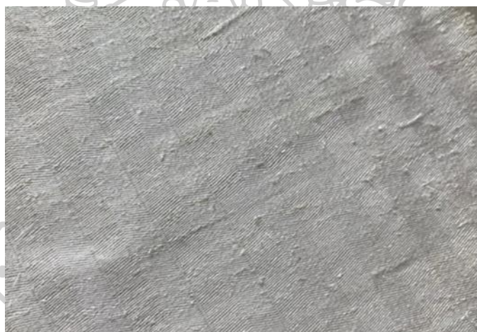
ภาพที่ 45 : แสดงภาพการทดลองทอแบบเส้นยืน พิวลาเจน 44 epi. พุ่งด้วยเส้นด้ายกล้วย
