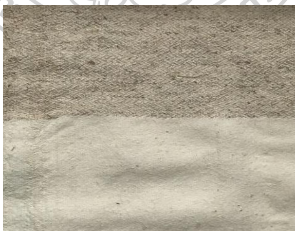
ภาพที่ 44 : แสดงภาพการทดลองทอแบบเส้นยืน ฟिलाเงิน 88 epi. พุ่งด้วยเส้นด้ายกล้วย ที่มา : รสริน ตำนานธารา, 2565
