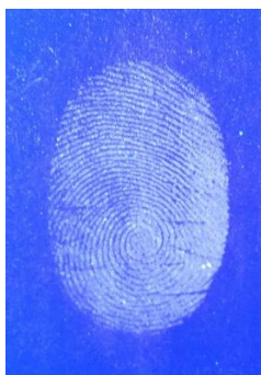
ภาพที่ 66 การใช้แกโดลิเนียมโมลิบดินัมบอเรตที่เจือด้วยเทอร์เบียม ( Tb^{3+} ) 0.05 mol% ทดสอบลายนิ้วมือแฝงบนกระจก
