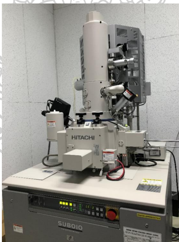
ภาพที่ 21 กล้องจุลทรรศน์อิเล็กตรอนแบบส่องกราด
