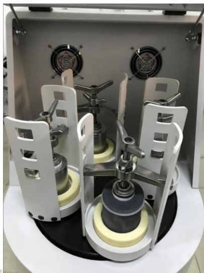
ภาพที่ 23 การเตรียมแต่ละตัวอย่างด้วยเครื่อง Planetary Ball Milling
