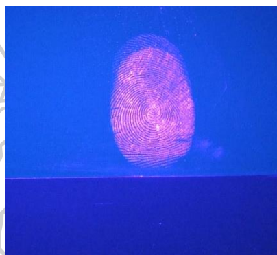
ภาพที่ 40 การใช้แกโดลิเนียมโมลิบดินัมบอเรตที่เจือด้วยยูโรเพียม ( \text{Eu}^{3+} ) 0.40 mol% ทดสอบลายนิ้วมือแฝงบนพื้นผิวพลาสติก จอภาพโทรทัศน์
