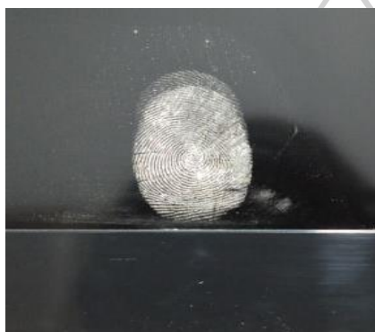
ภาพที่ 40 การใช้แกโดลิเนียมโมลิบดินัมบอเรตที่เจือด้วยยูโรเพียม ( \text{Eu}^{3+} ) 0.40 mol% ทดสอบลายนิ้วมือแฝงบนพื้นผิวพลาสติก จอภาพโทรทัศน์
