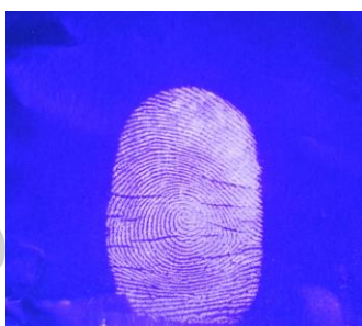
ภาพที่ 52 การใช้แกโดลิเนียมโมลิบดินัมบอเรตที่เจือด้วยซาแมเรียม ( Sm^{3+} ) 0.10 mol% ทดสอบลายนิ้วมือแฝงบนอะลูมิเนียมฟอยล์
