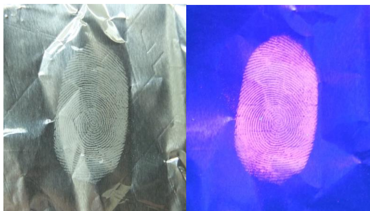
ภาพที่ 36 การใช้แกดโกลิเนียมโมลิบดินัมบอเรตที่เจือด้วยยูโรเพียม ( \text{Eu}^{3+} ) 0.40 mol% ทดสอบลายนิ้วมือแฝงบนอะลูมิเนียมพอยล์
