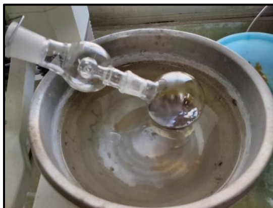
รูปภาพที่ 6 ระเหยแห้งด้วยเครื่อง Evaporator
