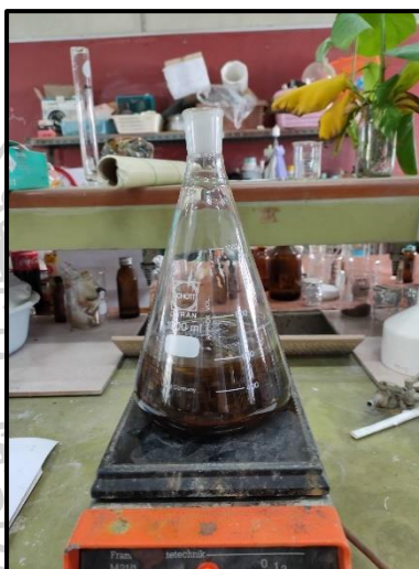
รูปภาพที่ 4 การ stirred สารตัวอย่างกับตัวทำละลายเอทานอล
