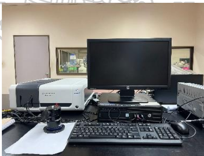
ภาพที่ 6 เครื่อง Agilent Cary 60 UV-Vis Spectrophotometer บริษัท Agilent Technologies Thailand
