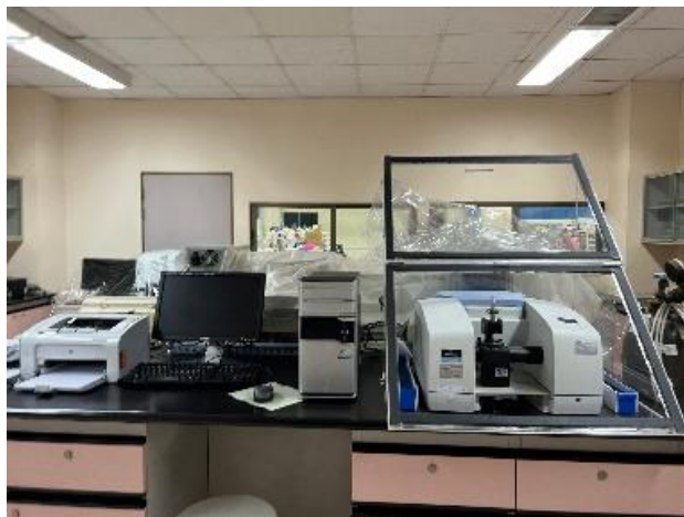
ภาพที่ 7 เครื่อง Fourier Transform Infrared Spectroscopy (FTIR) รุ่น Spectrum 100 บริษัท Perkin Elmer Thailand
