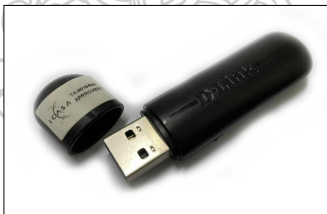
ภาพที่ 4.9 Wireless USB Adapter D-LINK (DWA-123) N150
