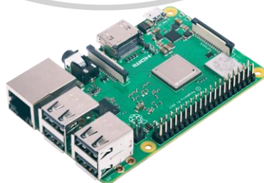
ภาพที่ 4.1 Raspberry Pi 3 Model B
