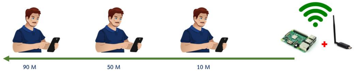
ภาพที่ 4.13 การวางระยะการทดลองตรวจจับสัญญาณ
