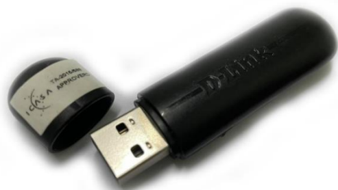
ภาพที่ 4.2 Wireless USB Adapter D-LINK (DWA-123) N150
