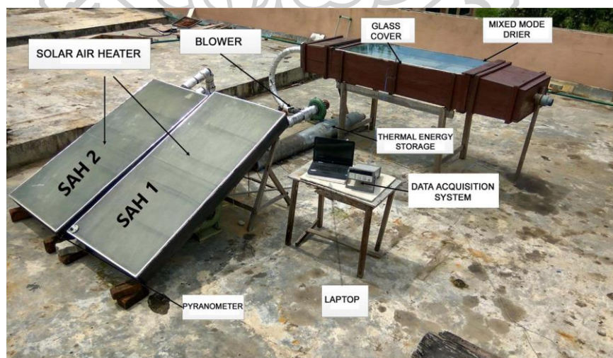
รูปที่ 25 เครื่องอบแห้งพลังงานแสงอาทิตย์ประเภทการพาความร้อนแบบบังคับอากาศแบบรับรังสีอาทิตย์แบบผสม (Lakshmi, Muthukumar, Layek, & Nayak, 2019)
