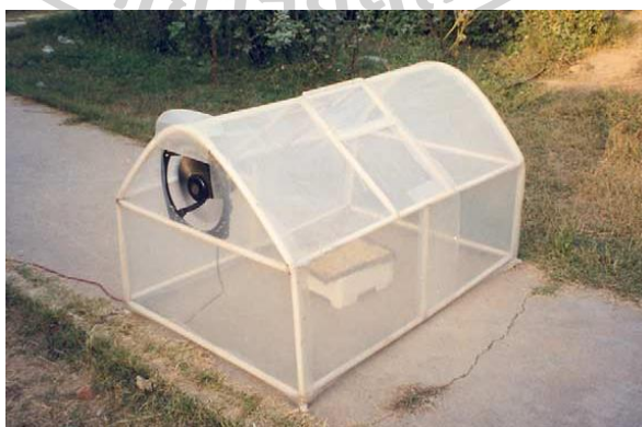
รูปที่ 21 เครื่องอบแห้งพลังงานแสงอาทิตย์ประเภทพาความร้อนแบบบังคับอากาศแบบรับรังสีอาทิตย์โดยตรง (Jain & Tiwari, 2004)
