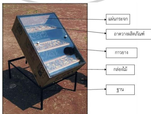
รูปที่ 15 เครื่องอบแห้งพลังงานแสงอาทิตย์ประเภทพาความร้อนตามธรรมชาติแบบรับรังสีอาทิตย์โดยตรง (ดัดแปลงจาก Mane, 2017)
