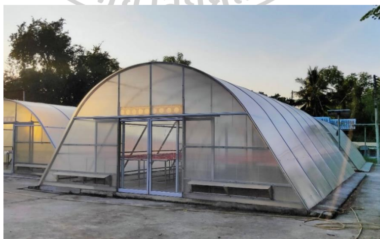
รูปที่ 33 เครื่องอบแห้งพลังงานแสงอาทิตย์แบบพาราโบลาที่ใช้ในงานวิจัยนี้
