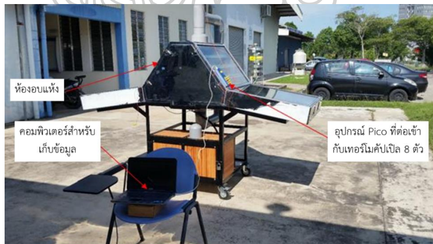
รูปที่ 19 เครื่องอบแห้งพลังงานแสงอาทิตย์ประเภทการพาความร้อนตามธรรมชาติแบบรับรังสีอาทิตย์แบบผสม (ดัดแปลงจาก Misha, Alqadhi, Mohd Rosli, & Yusof, 2018)
