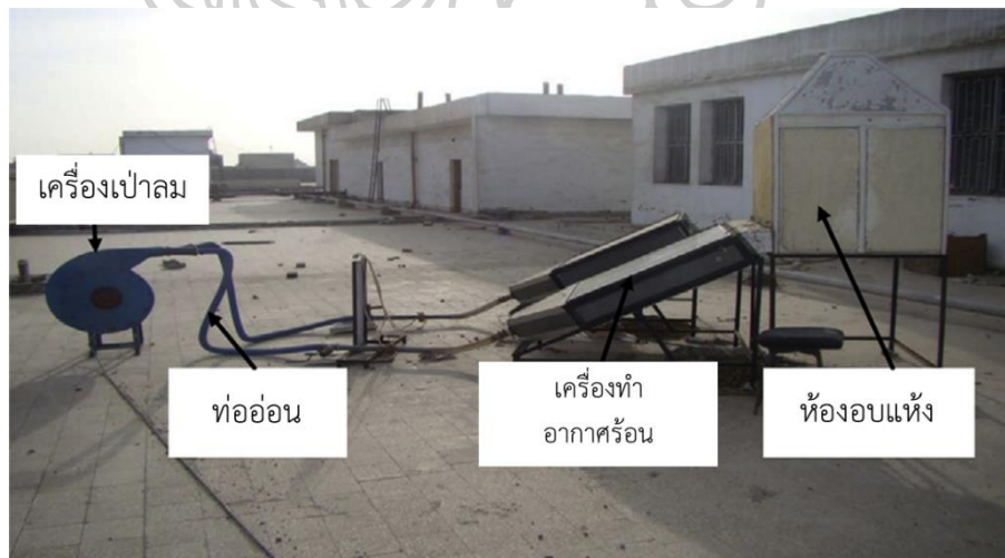
รูปที่ 23 เครื่องอบแห้งพลังงานแสงอาทิตย์ประเภทการพาความร้อนแบบบังคับอากาศแบบรับรังสีอาทิตย์โดยอ้อม (ดัดแปลงจาก El-Sebaii & Shalaby,2013)
