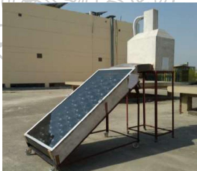
รูปที่ 17 เครื่องอบแห้งพลังงานแสงอาทิตย์ประเภทการพาความร้อนตามธรรมชาติแบบรับรังสีอ้อมโดยอ้อม (Babar, Tarafdar, Malakar, Arora, & Nema, 2020)
