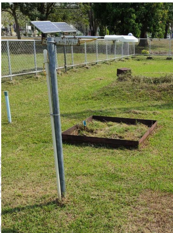
รูปที่ 23 รูปเครื่อง CNR4 สำหรับวัดรังสีสุทธิที่สถานีนครปฐม
