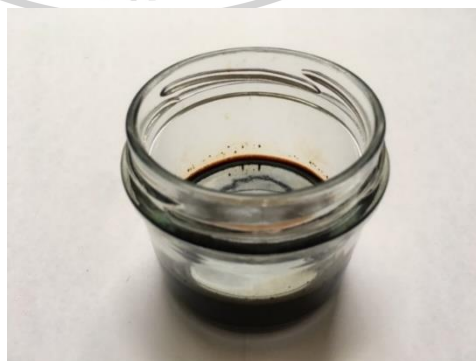
รูปที่ 4.3ค ของเหลวที่ได้จากการควบแน่นทอรีแฟคชันที่อุณหภูมิ 270 °C
