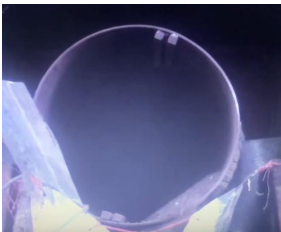
4.24ก การเคลื่อนที่ของวัสดุในเตาเผาแบบหมุนแบบไม่มีใบกวน
