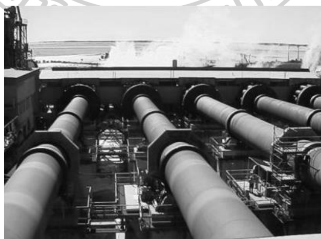
รูปที่ 2.9 เตาเผาแบบแห้งชนิดยาว ( Long Dry Kilns)
