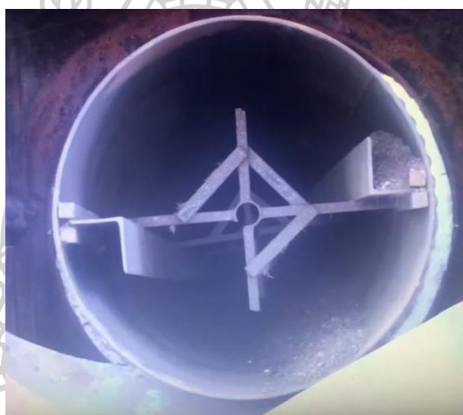
4.24ข การเคลื่อนที่ของวัสดุในเตาเผาแบบหมุนแบบมีใบกวน 2 ใบ
