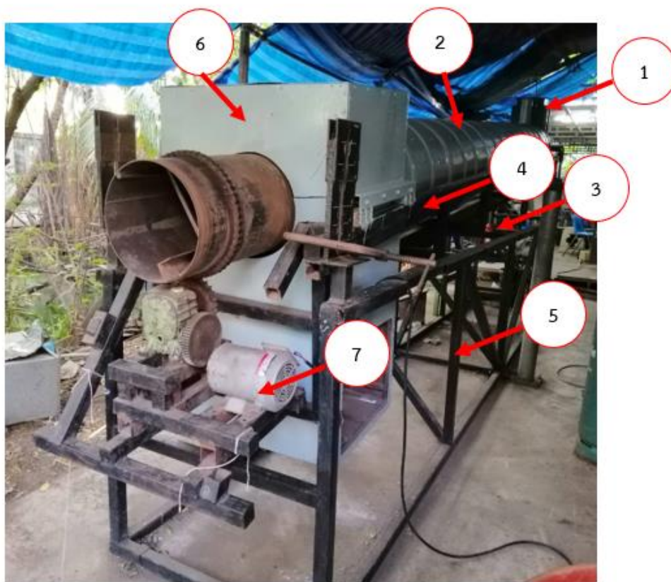
รูปที่ 3.4 เตาเผาแบบหมุนสำหรับกระบวนการทอรีแฟคชั่น
