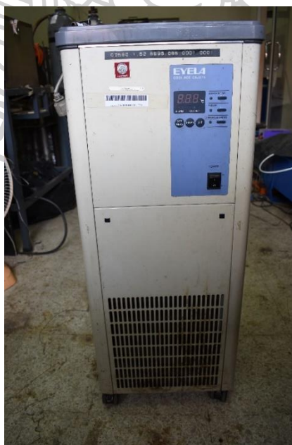
รูปที่ 3.5 เครื่องทำน้ำเย็น (Cold Bath eyela cool ace ca-1111)
