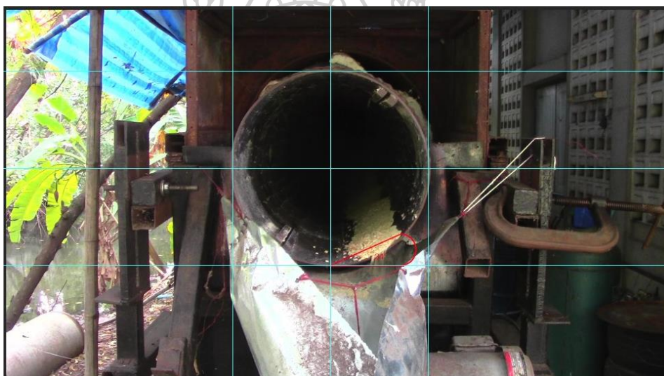
รูปที่ 3.13 การหาค่ามุมรีโพลของวัสดุภายในเตาเผาแบบหมุน
