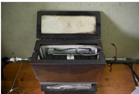
รูปที่ 3.3 เต้าเผาแบบ fix bed สำหรับกระบวนการทอรีแฟคชั่น
