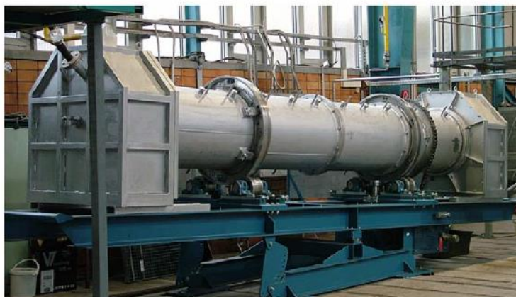
รูปที่ 2.18 เตาเผาชนิดโรตารีที่ใช้ในการทดลอง
